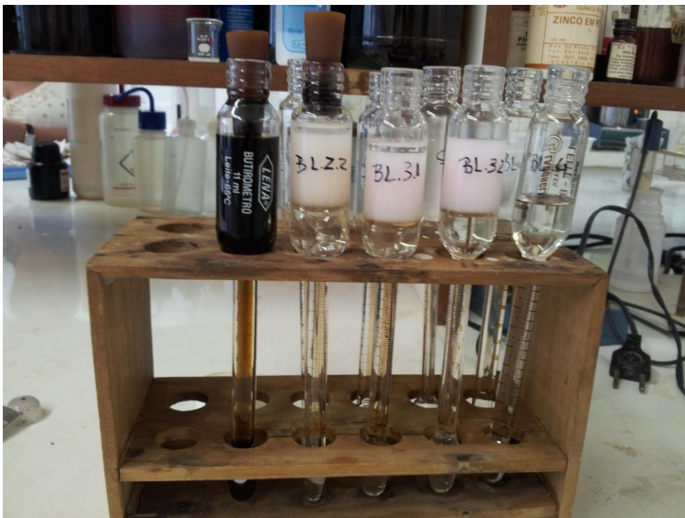
Imagem 7. Passo a passo do procedimento para análise de gordura (Butirômetros de Gerber).
