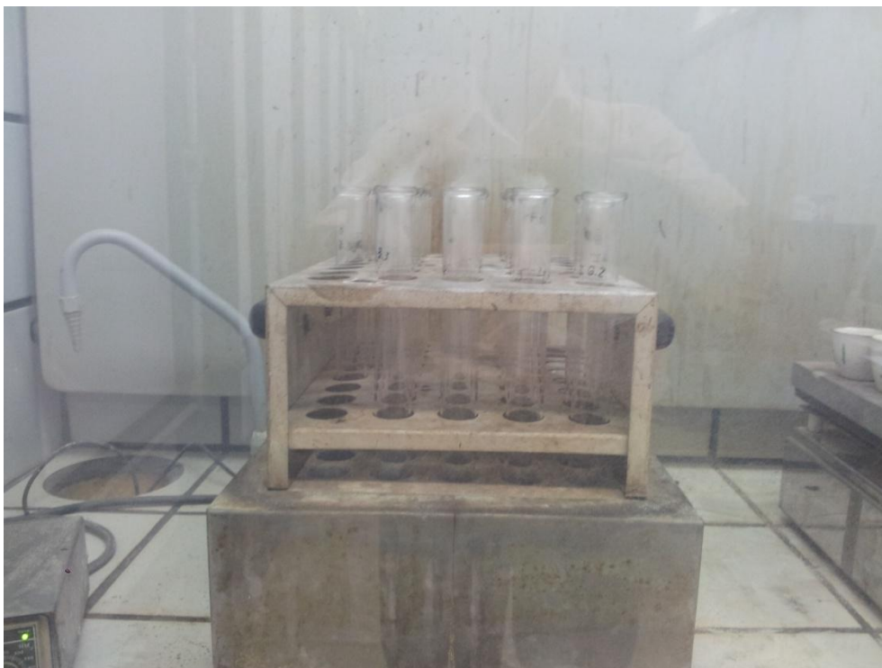
Imagem 6. Amostras de Bebidas Lácteas e Iogurtes em bloco digestor para análise de Proteína.
