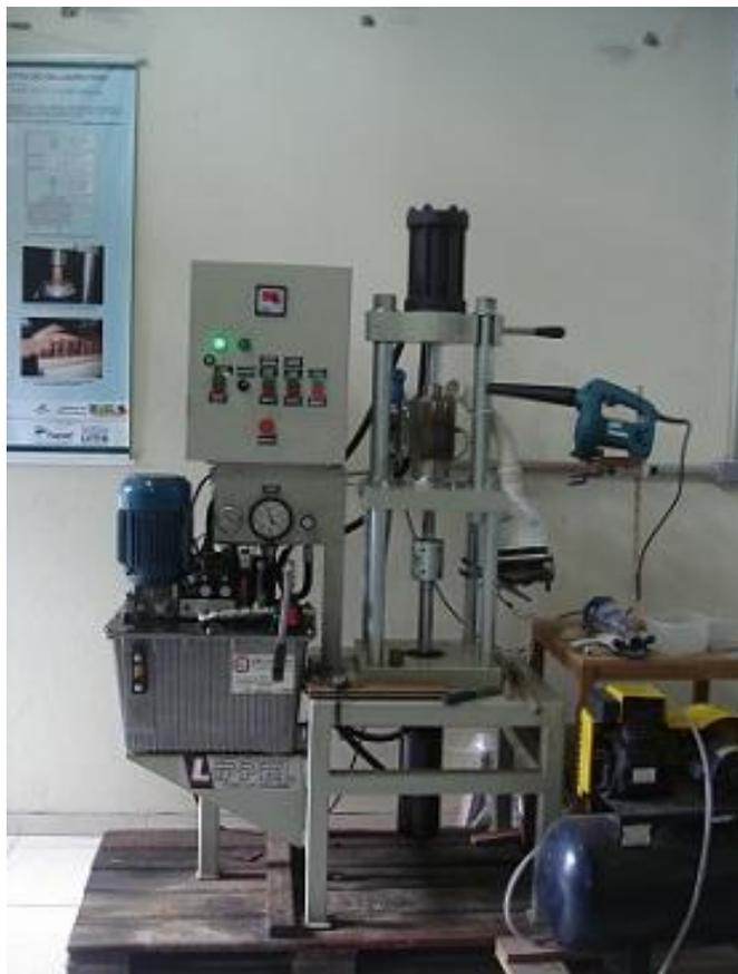
Figura 3: Briquetadeira utilizada para confecção dos briquetes de resíduos agrícolas
