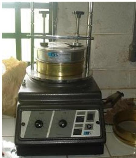
Figura 2: Classificador utilizado para obtenção das partículas dos resíduos agrícolas
