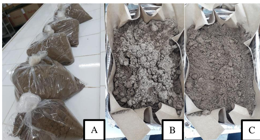
Figura 4. Aplicação de água destilada (A) e processo de secagem (B e C).
