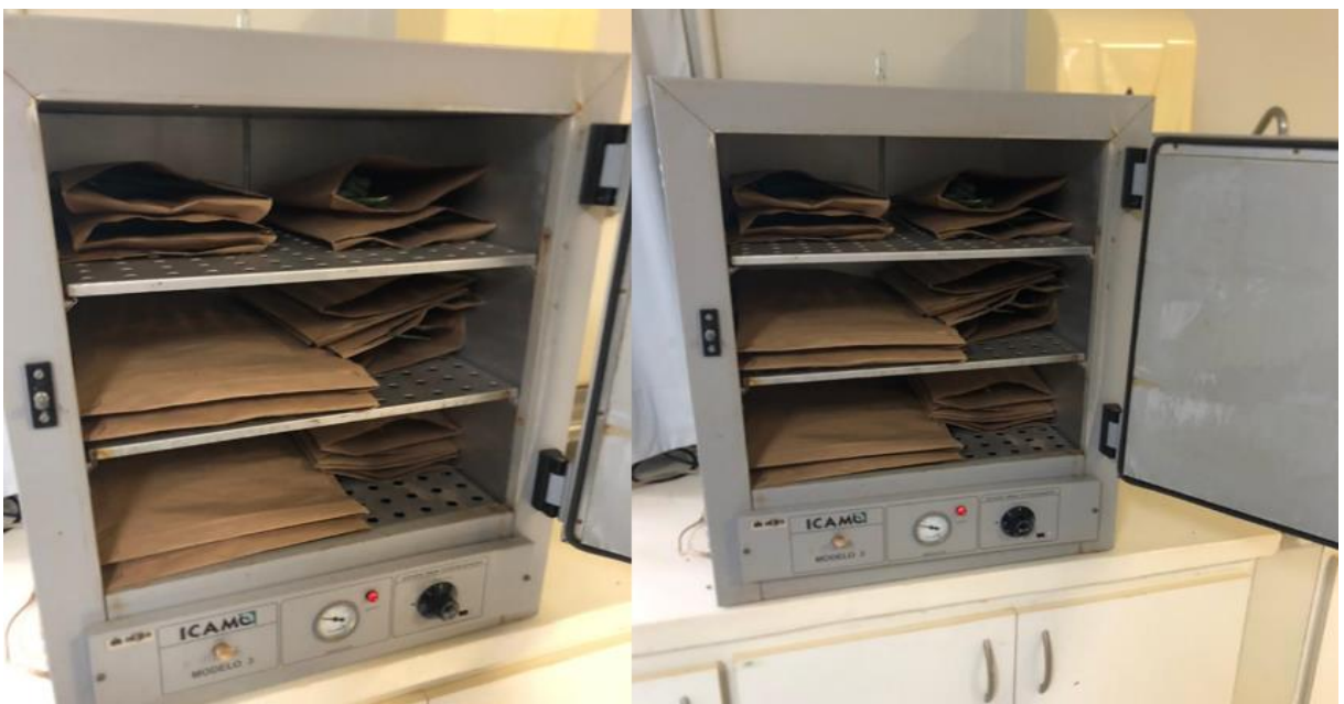
Figura 7. Material separado para avaliar a matéria seca, em estufa a 60°C, até a massa constante FAL-UnB, 2024.
