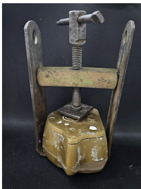
Figura 8 - Mufla em prensa manual para completa polimerização da prótese nasal em silicone. Fonte: acervo pessoal.
