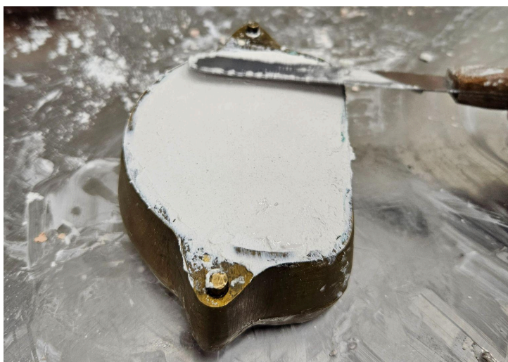
Figura 6 - Inclusão do protótipo em mufla metálica e gesso tipo II. Fonte: acervo pessoal.
