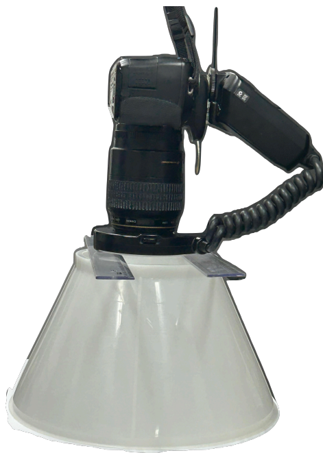
Figura 3: Padronização da distância de fotografia com um cone de posicionamento.
