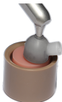
Figura 1: Dispositivo para padronização da distancia de jateamento em 10mm.
