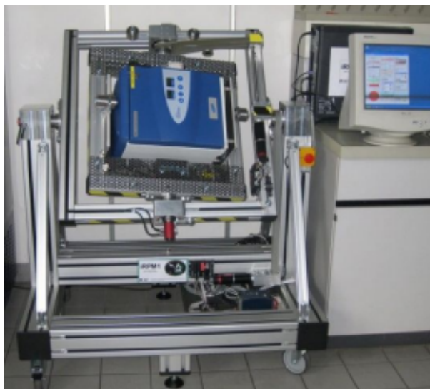
Figura 3 – Clinóstato 3D do Laboratório de Medicina Espacial e Farmacologia Espacial, Universidade de Aarhus, Dinamarca.
