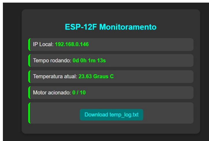
Figura 43 – Interface de acesso local para download e acesso das informações do ESP8266. Fonte: Autor.
