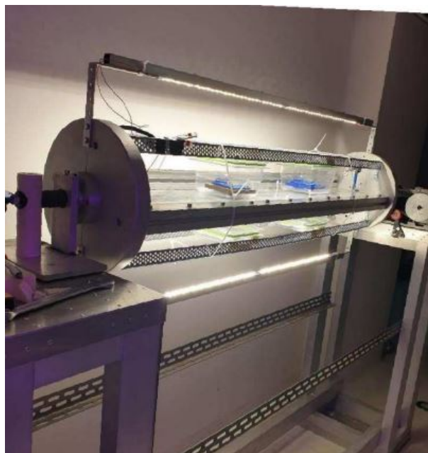
Figura 2 – Clinóstato de eixo único (1D) Fonte: Metelli (2021).
