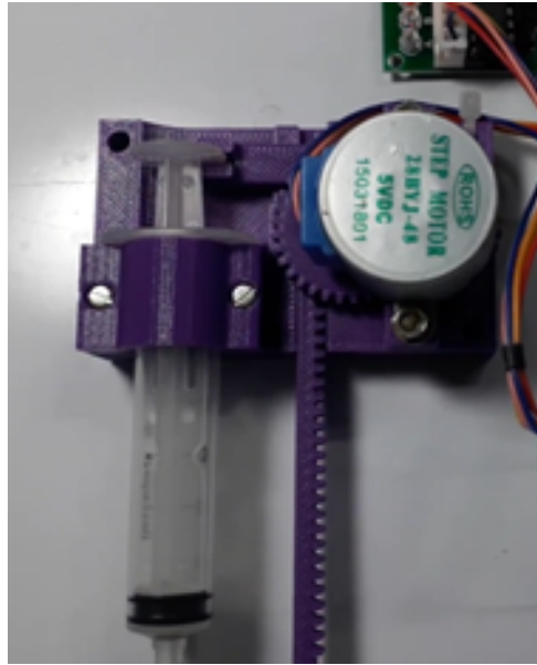
Figura 29 – Opção de sistema para administração de água utilizando impressão 3D e motor de passo.
