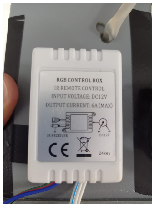
Figura 45 – Caixa de controle de iluminação Fonte: Autor.
