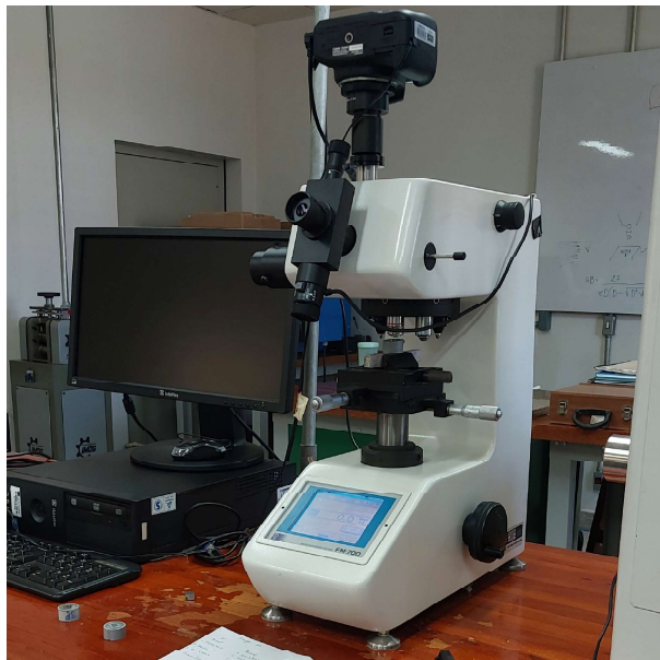
Figura 15 – Equipamento FM-700 utilizado para a realização dos ensaios de dureza Vickers.
