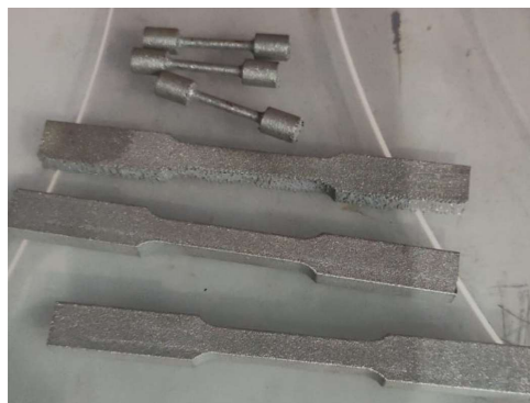
Figura 7 – Corpos de prova logo após a impressão sem acabamento superficial.
