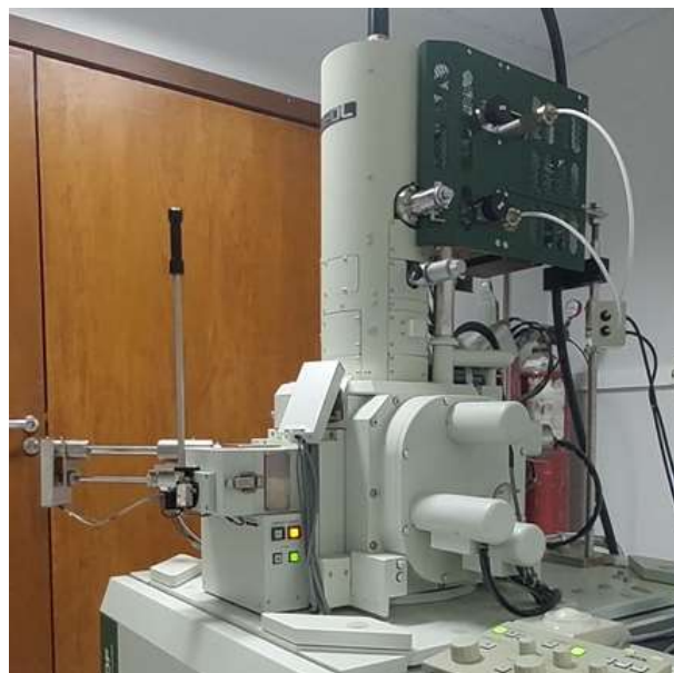
Figura 17 – Equipamento JEOL JSM 7001F usado para a análise MEV.
