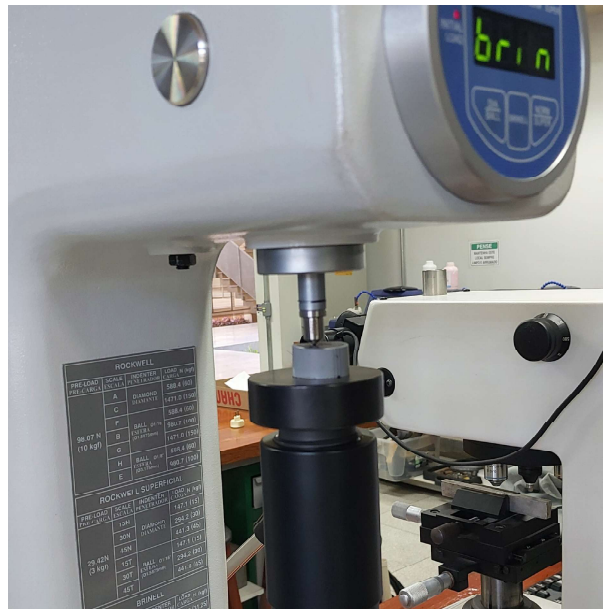
Figura 14 – Execução de um ensaio de dureza Brinell na máquina Mitutoyo.
