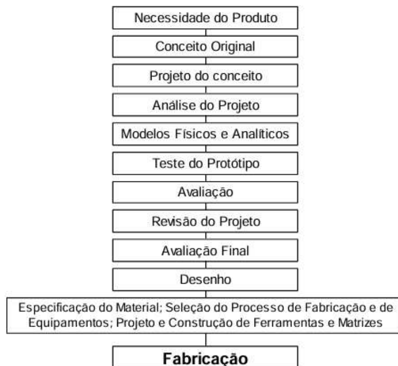
Figura 3 – Diagrama de procedimentos que devem ser realizados em um projeto até a etapa de fabricação ( MACHADO; SILVA, 2004 ).
