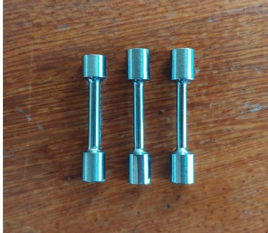
Figura 11 – Corpos de prova usinados ( CP1/2/3_{Usinado} ).
