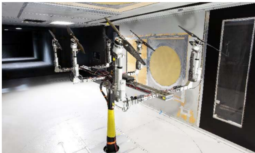
Figura 7 – MTB instalado no túnel de vento do Exército dos EUA. Fonte: Russell and Conley (2020)
