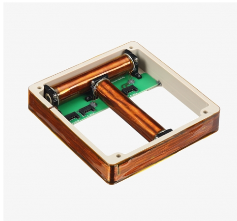
Figura 2.11 – Magnetorques para 3 eixos. Fonte: (Wu; Shan, 2019)
