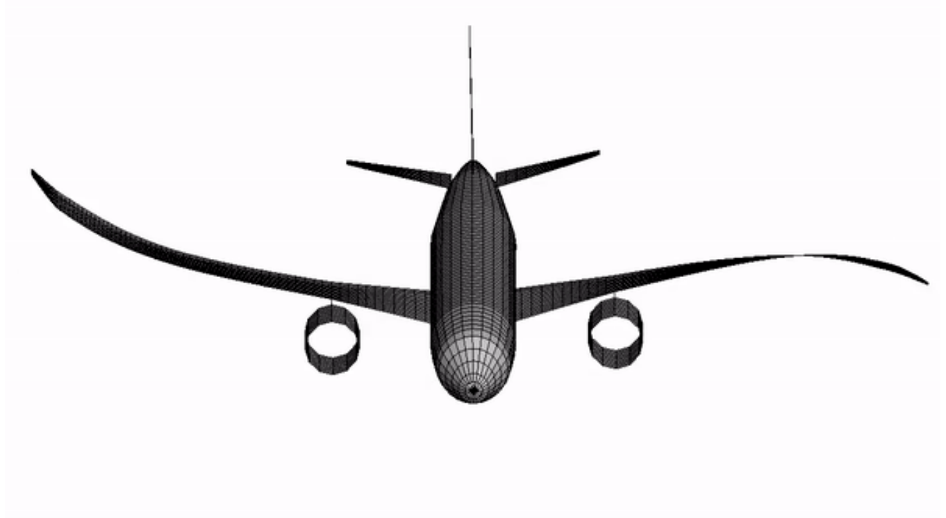
Figura 5 – Deformações típicas devido ao Flutter . Fonte: MICHELI (2024)
