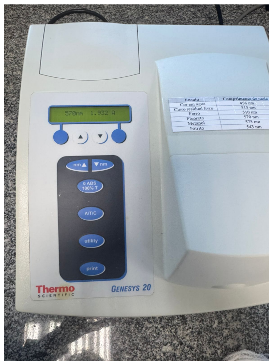
Figura 22: amostras sendo analisadas no espectrofotômetro. Fonte: autora.
