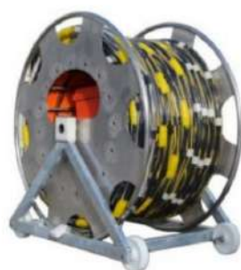
Figura 23 – Streamer utilizado durante a aquisição da campanha AMANAUS (Dupont, 2023).
