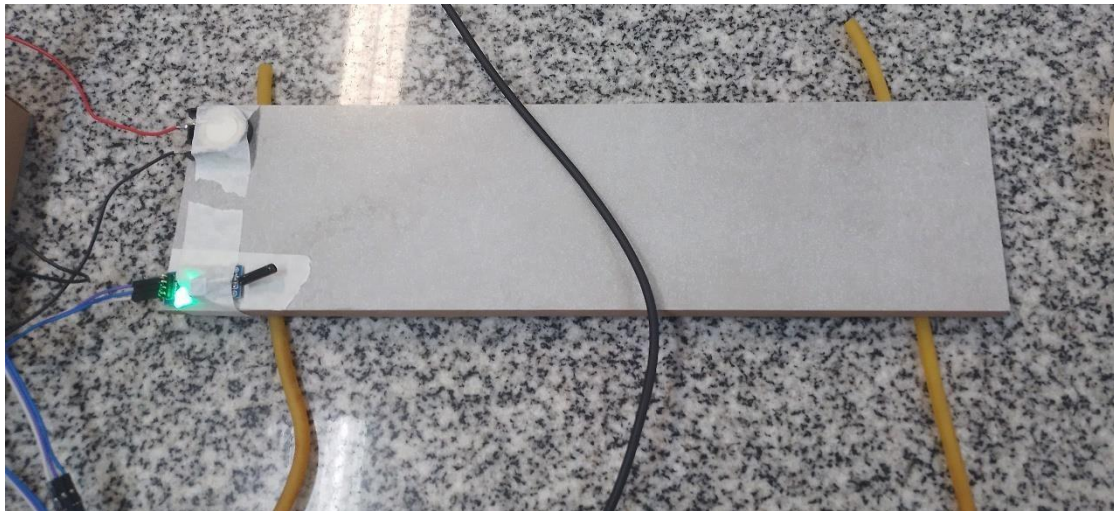
Figura 12: Montagem experimental com a cerâmica (Sensor Piezo Buzzer e SW-18010P)
