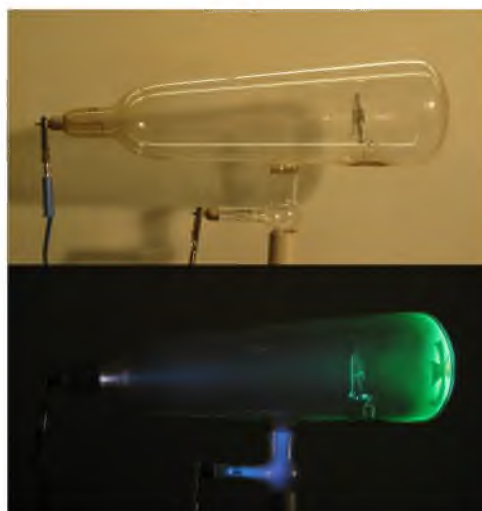
Figura 2.1 – Foto do tubo de Crookes Fonte: (Giakoumakis, 2022).
