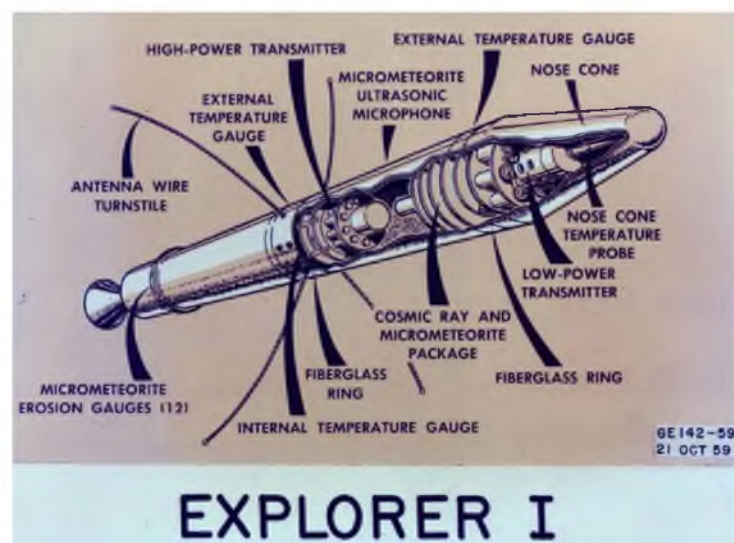
Figura 2.5 – Equipamentos no satélite da missão Explorer I. Fonte: NASA.
