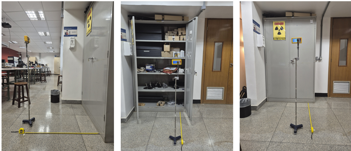
Figura 25 – Imagens do setup montado para aferição das taxas de dose do local
