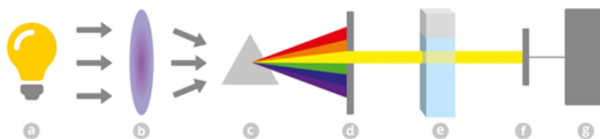
Figura 10 – Diagrama de funcionamento de um espectrofotômetro: (a) Fonte de luz, (b) Lente colimadora, (c) Prisma ou rede de difração, (d) Fenda seletora, (e) Cubeta (vidro, quartzo), (f) Detector, (g) Leitor. (Ciência em Ação, )
