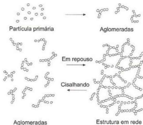
Figura 5: Ilustração da interação de partículas em dispersões tixotrópicas. Retirado de: (SCHRAMM, 2006).
