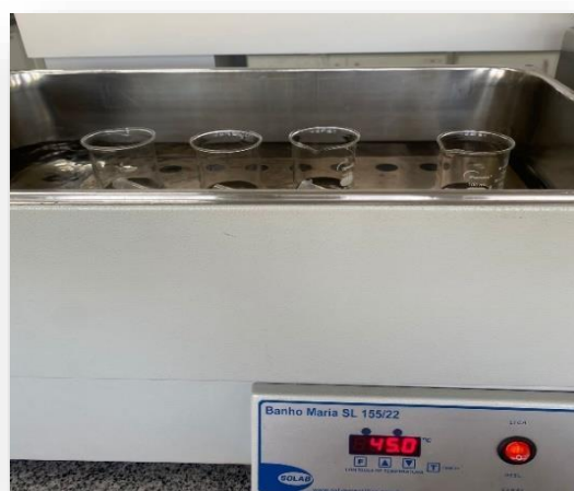
Figura 5 – Fotografia ilustrativa do estresse térmico em gel facial desenvolvido, realizado em banho-maria.
