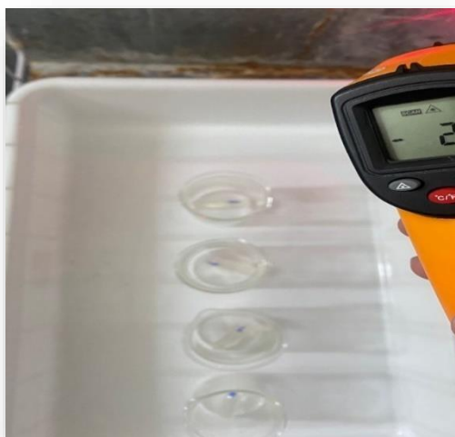
Figura 6 - Amostras submetidas à temperatura média de 2° C durante 30 minutos. Fonte: Autora, 2023.
