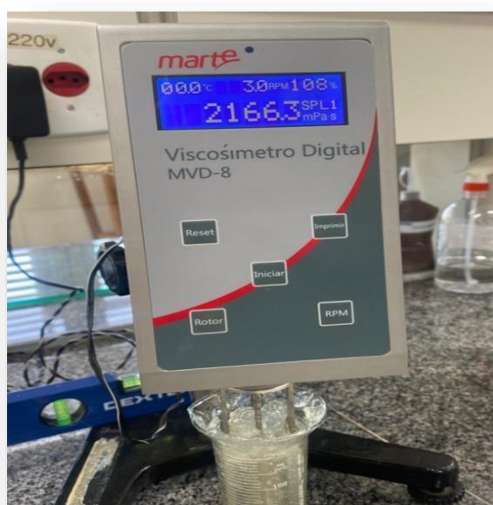
Figura 8 – Fotografia ilustrativa da avaliação da viscosidade do gel facial desenvolvido em viscosímetro Marte Digital (MDV-8)
