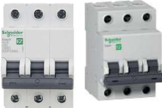
**Disjuntor tripolar tipo din de 4,5Ka de 70A até 125A:** Os disjuntores tripolares, para trilho din dessa faixa de corrente de curto-círcuito de 4500 amperes, eles devem seguir as normas ABNT NBR NM 60898 e a IEC 60947-2, ter curva tipo C de atuação, tensão de operação de 400V, em 60Hz, seccionamento aparente e fechamento brusco, com capacidade de interrupção de 4kV, IP20 de forma isolada e IP40 quando dentro de um quadro, com 7.000
