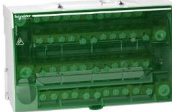
**Conector para cabos de 35mm<sup>2</sup> e 50mm<sup>2</sup>:** Conector de alimentação para cabos de 35mm<sup>2</sup> e 50mm<sup>2</sup>, com revestimento plástico isolante de 500V, em conformidade com a norma IEC 60947-7-1, tensão de operação de 415 V, capacidade de suportabilidade de correntes de curto-circuito de 6.000 amperes. Tecnicamente compatível com os fabricantes de referência ABB, Schneider,Siemens, STECK e WEG.
