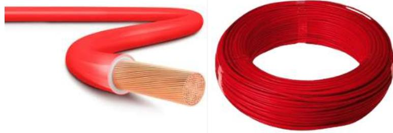
**Condutor de 70mm<sup>2</sup> com cobertura PVC :** Condutor de cobre flexível de 70mm<sup>2</sup>, com cobertura PVC antichama, com suportabilidade de 70°C em serviço contínuo, com grau de isolação de 750V, 100°C em sobrecarga e 160°C em curto-circuito, atendendo as normas NBR NM 247-3 e a NBR 5410. Tecnicamente compatível com os fabricantes de referência Prysmian, Condumax e Eurobras.
