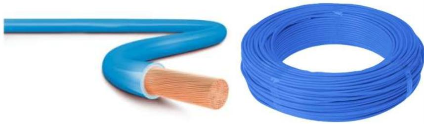
**Condutor de 95mm<sup>2</sup> com cobertura PVC :** Condutor de cobre flexível de 95mm<sup>2</sup>, com cobertura PVC antichama, com suportabilidade de 70°C em serviço contínuo, com grau de isolação de 750V, 100°C em sobrecarga e 160°C em curto-circuito, atendendo as normas NBR NM 247-3 e a NBR 5410. Tecnicamente compatível com os fabricantes de referência Prysmian, Condumax e Eurobras.
