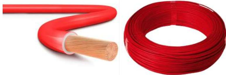
**Condutor de 10mm<sup>2</sup> com cobertura PVC :** Condutor de cobre flexível de 10mm<sup>2</sup>, com cobertura PVC antichama, com suportabilidade de 70°C em serviço contínuo, com grau de isolação de 750V, 100°C em sobrecarga e 160°C em curto-circuito, atendendo as normas NBR NM 247-3 e a NBR 5410. Tecnicamente compatível com os fabricantes de referência Prysmian, Condumax e Eurobras.
