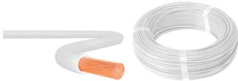
**Condutor de 630mm<sup>2</sup> com cobertura PVC :** Condutor de cobre flexível de 630mm<sup>2</sup>, com cobertura PVC antichama, com suportabilidade de 70°C em serviço contínuo, com grau de isolação de 750V, 100°C em sobrecarga e 160°C em curto-circuito, atendendo as normas NBR NM 247-3 e a NBR 5410. Tecnicamente compatível com os fabricantes de referência Prysmian, Condumax e Eurobras.
