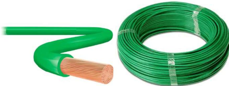
**Condutor de 120mm<sup>2</sup> com cobertura PVC :** Condutor de cobre flexível de 120mm<sup>2</sup>, com cobertura PVC antichama, com suportabilidade de 70°C em serviço contínuo, com grau de isolação de 750V, 100°C em sobrecarga e 160°C em curto-circuito, atendendo as normas NBR NM 247-3 e a NBR 5410. Tecnicamente compatível com os fabricantes de referência Prysmian, Condumax e Eurobras.
