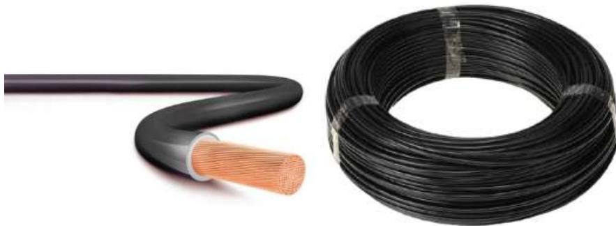
**Condutor de 400mm<sup>2</sup> com cobertura PVC :** Condutor de cobre flexível de 400mm<sup>2</sup>, com cobertura PVC antichama, com suportabilidade de 70°C em serviço contínuo, com grau de isolação de 750V, 100°C em sobrecarga e 160°C em curto-circuito, atendendo as normas NBR NM 247-3 e a NBR 5410. Tecnicamente compatível com os fabricantes de referência Prysmian, Condumax e Eurobras.
