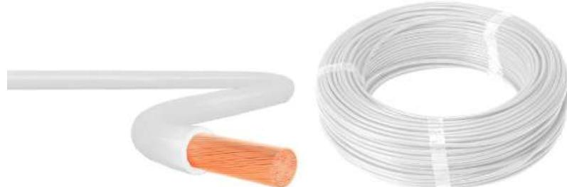
**Condutor de 50mm<sup>2</sup> com cobertura PVC :** Condutor de cobre flexível de 50mm<sup>2</sup>, com cobertura PVC antichama, com suportabilidade de 70°C em serviço contínuo, com grau de isolação de 750V, 100°C em sobrecarga e 160°C em curto-circuito, atendendo as normas NBR NM 247-3 e a NBR 5410. Tecnicamente compatível com os fabricantes de referência Prysmian, Condumax e Eurobras.
