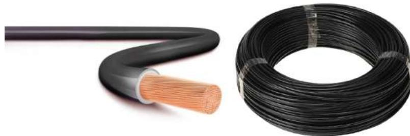
**Condutor de 35mm<sup>2</sup> com cobertura PVC :** Condutor de cobre flexível de 35mm<sup>2</sup>, com cobertura PVC antichama, com suportabilidade de 70°C em serviço contínuo, com grau de isolação de 750V, 100°C em sobrecarga e 160°C em curto-circuito, atendendo as normas NBR NM 247-3 e a NBR 5410. Tecnicamente compatível com os fabricantes de referência Prysmian, Condumax e Eurobras.
