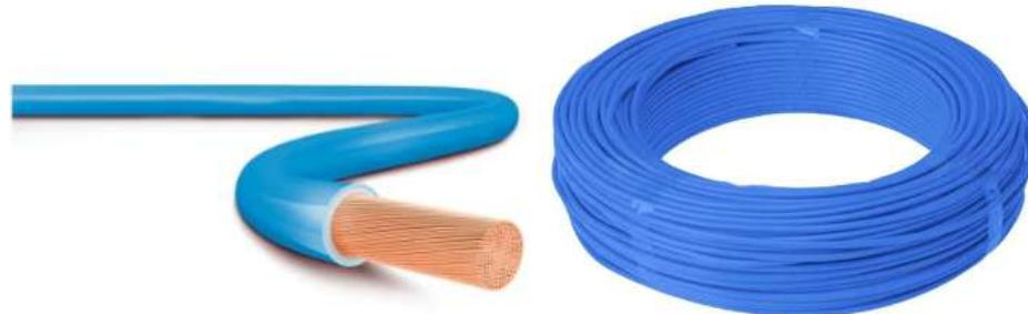
**Condutor de 16mm<sup>2</sup> com cobertura PVC :** Condutor de cobre flexível de 16mm<sup>2</sup>, com cobertura PVC antichama, com suportabilidade de 70°C em serviço contínuo, com grau de isolação de 750V, 100°C em sobrecarga e 160°C em curto-circuito, atendendo as normas NBR NM 247-3 e a NBR 5410. Tecnicamente compatível com os fabricantes de referência Prysmian, Condumax e Eurobras.
