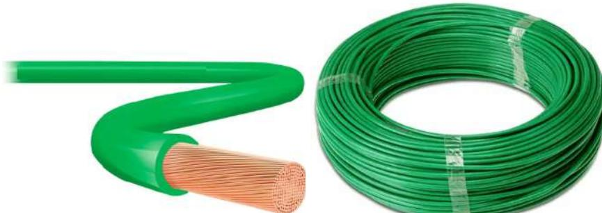
**Condutor de 25mm<sup>2</sup> com cobertura PVC :** Condutor de cobre flexível de 25mm<sup>2</sup>, com cobertura PVC antichama, com suportabilidade de 70°C em serviço contínuo, com grau de isolação de 750V, 100°C em sobrecarga e 160°C em curto-circuito, atendendo as normas NBR NM 247-3 e a NBR 5410. Tecnicamente compatível com os fabricantes de referência Prysmian, Condumax e Eurobras.
