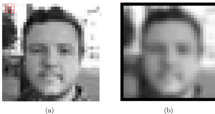
Figura 2.7: Processo de convolução da imagem para o segundo pixel
