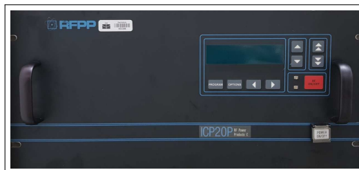
Figura 9 – Gerador de Radiofrequência da RFPP
