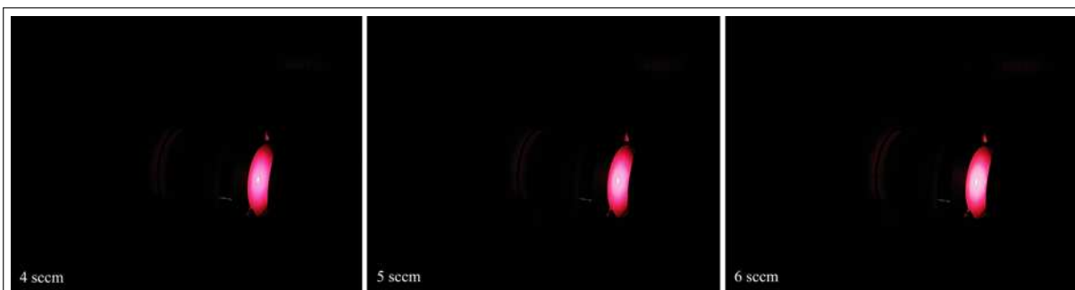
Figura 41 – Brilho Emitido pelo Fluxo de Elétrons em 4, 5 e 6 sccm
