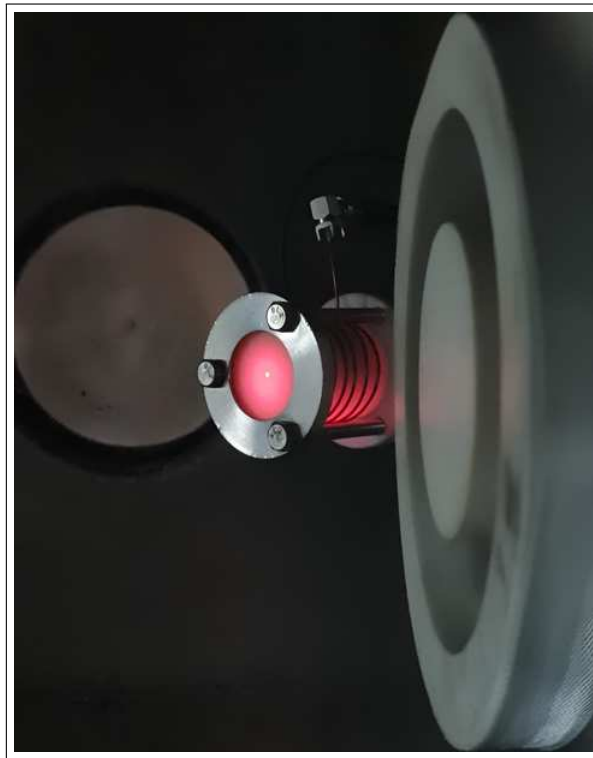
Figura 53 – Cátodo de RF com PHall II-C na Câmara de Vácuo
