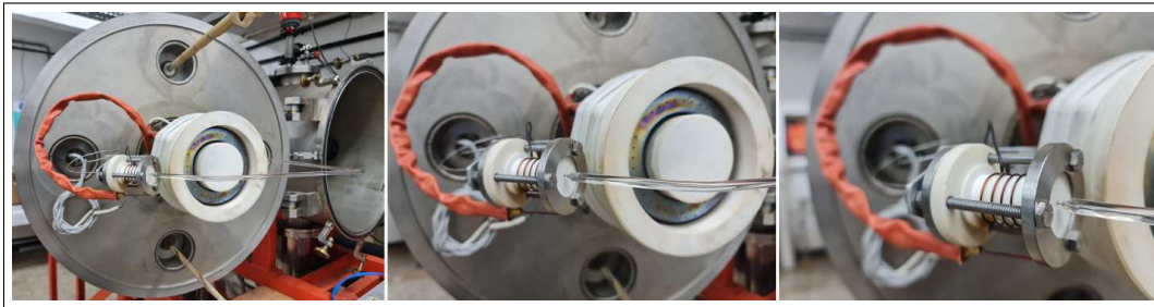
Figura 43 – Localização Axial da Sonda de Langmuir no Cátodo de RF
