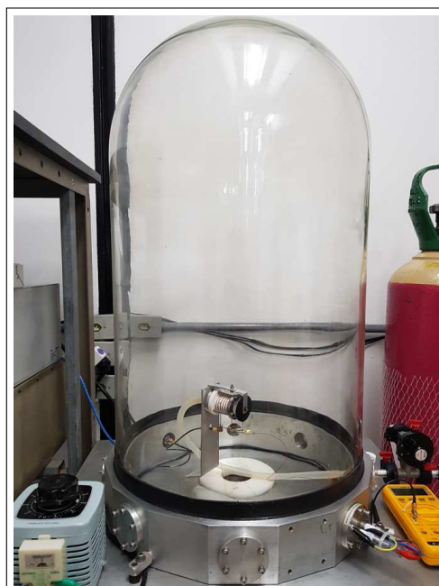
Figura 34 – Cátodo Experimental em Sistema de Testes Fechado
