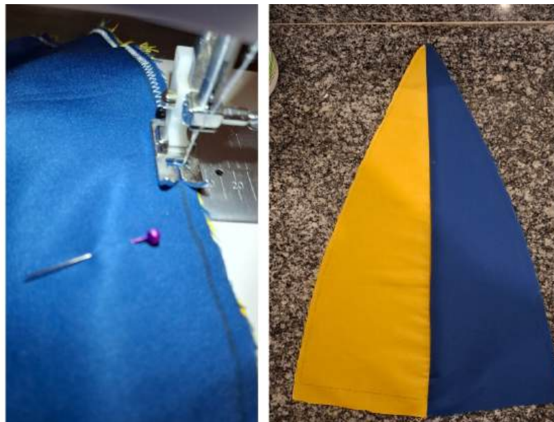
Figura D.3 – Junção dos gomos 2 a 2
