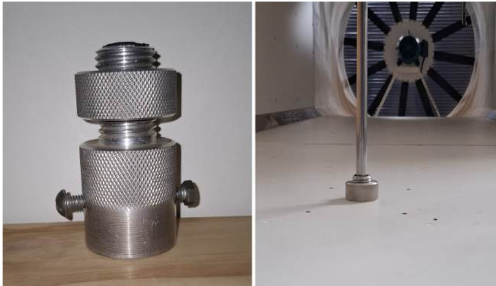
Figura 3.10 – Fixação da parte inferior da haste
