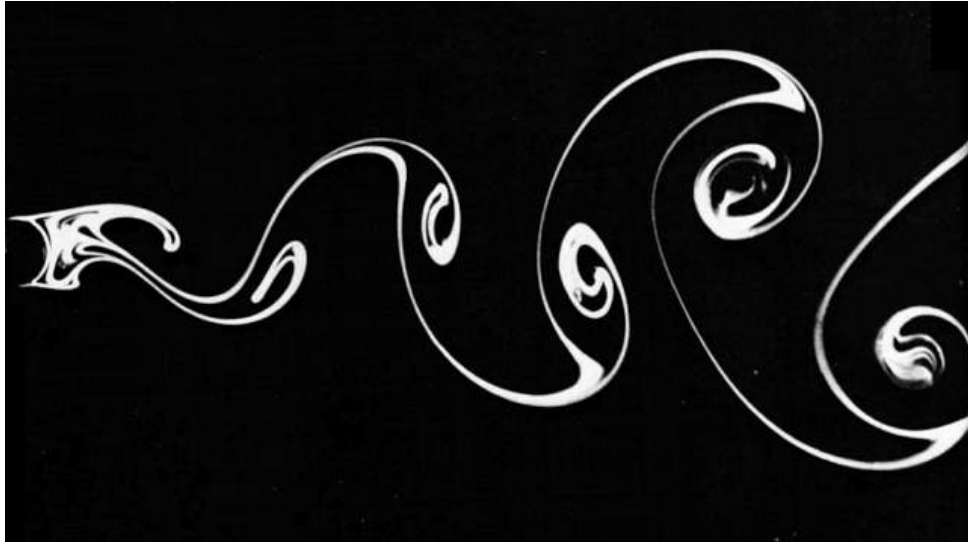
Figura 2.2 – Vórtice de Von Kármán atrás de um cilindro circular para Reynolds de 140
