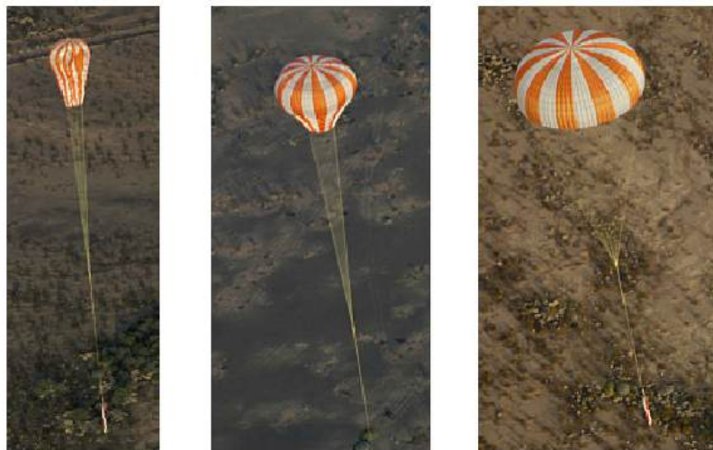
Figura 2.7 – Estágios de reefing do paraquedas do CPAS
