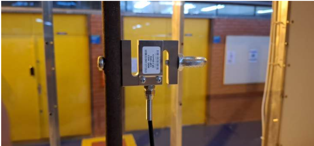
Figura 3.12 – Acoplamento da célula de carga na haste
