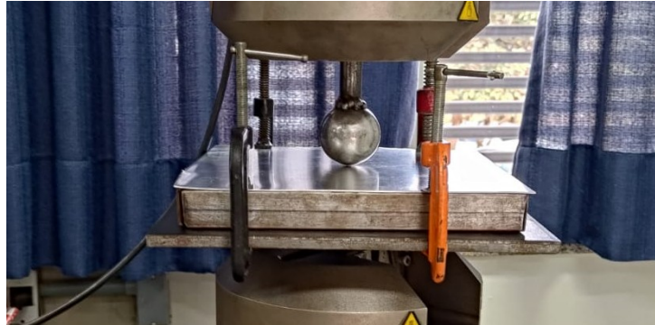
Figura 16 – Estrutura de fixação das placas de 1 mm de alumínio na máquina de ensaio para 2 lados apoiados e 2 lados engastados.
