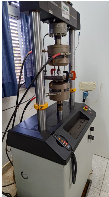
Figura 14 – Montagem experimental do teste quasi-estático com esfera de impacto.
