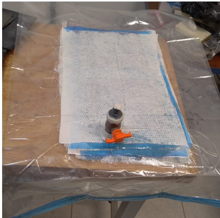
Figura 23 – Processo de laminação a vácuo das placas de PETG com fibra de vidro e resina epóxi.
