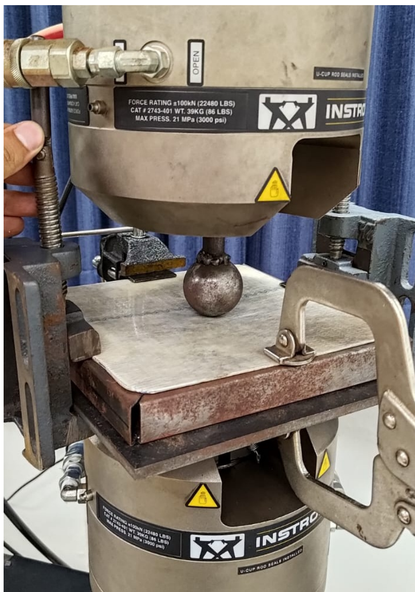
Figura 21 – Fixação da placa reforçada com todas as bordas engastadas. Fonte: Autor, 2024.
