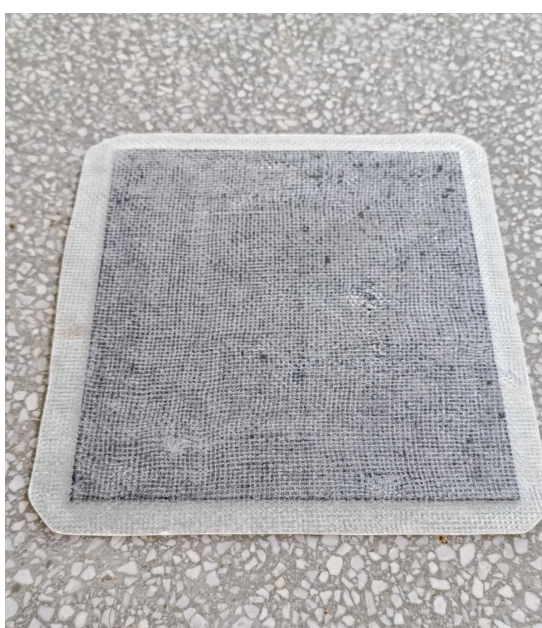
Figura 25 – Placas compostas com duas cavidades impressas e reforço laminar aplicado.
