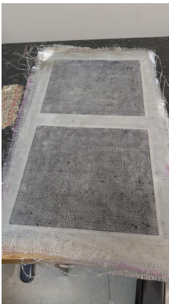
Figura 24 – Placa composta finalizada após corte e lixamento.
