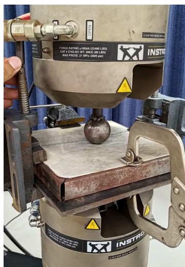
Figura 15 – Estrutura de fixação das placas de 2 mm de alumínio na máquina de ensaio para todos os lados engastados.
