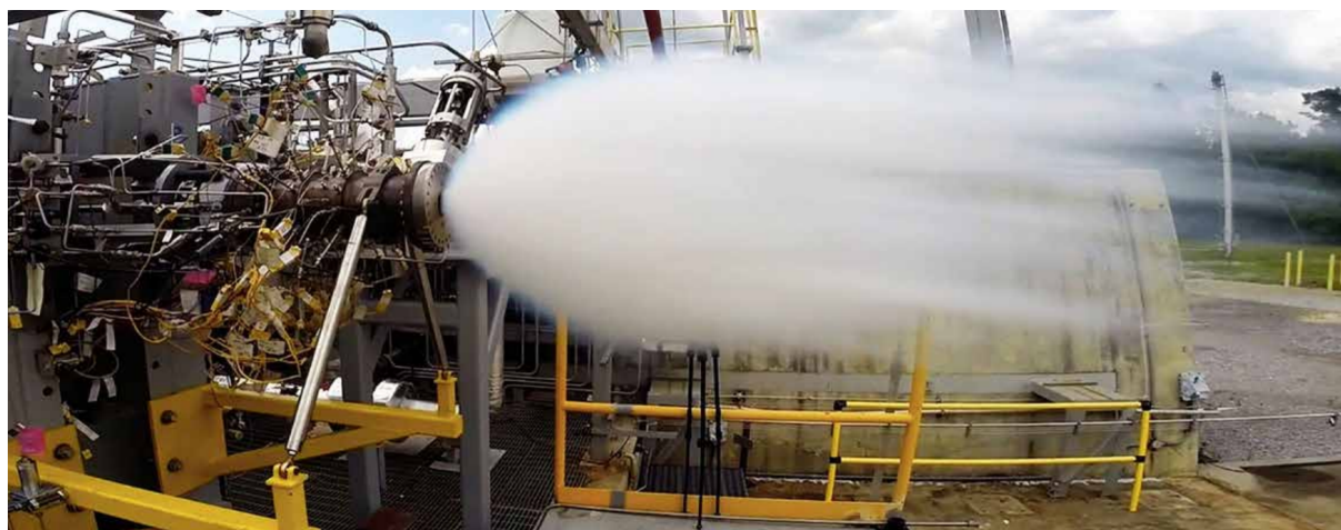
Figura 7 – Operadores no Banco de Testes E-2 no Stennis realizam teste do pré-combustor de oxigênio do motor Raptor da SpaceX, destinado a voos para Marte.
