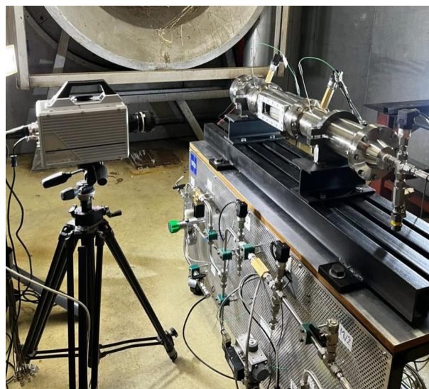
Figura 5 – Configuração dos equipamentos e da bancada de testes do MOUETTE ( R. GELAIN et al., 2022 )
