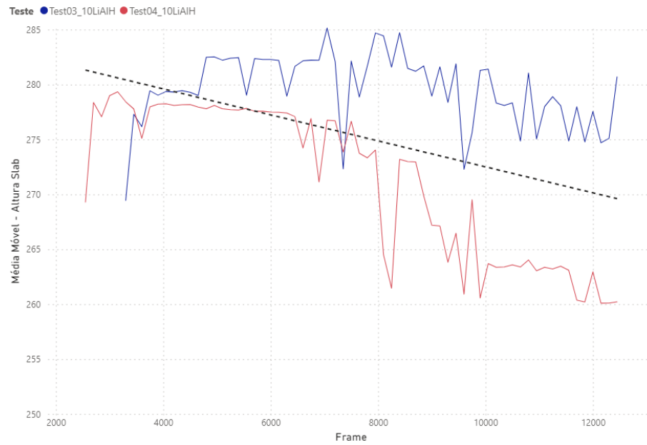
Figura 19 – Comparação da Média Móvel da Posição em Pixels x Frame do Combustível Sólido para Testes com 1% de LiAlH
