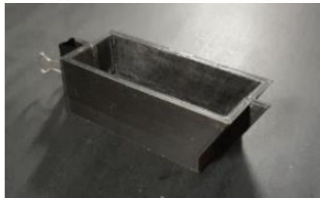
(b) Molde do grão combustível impresso em 3D.
