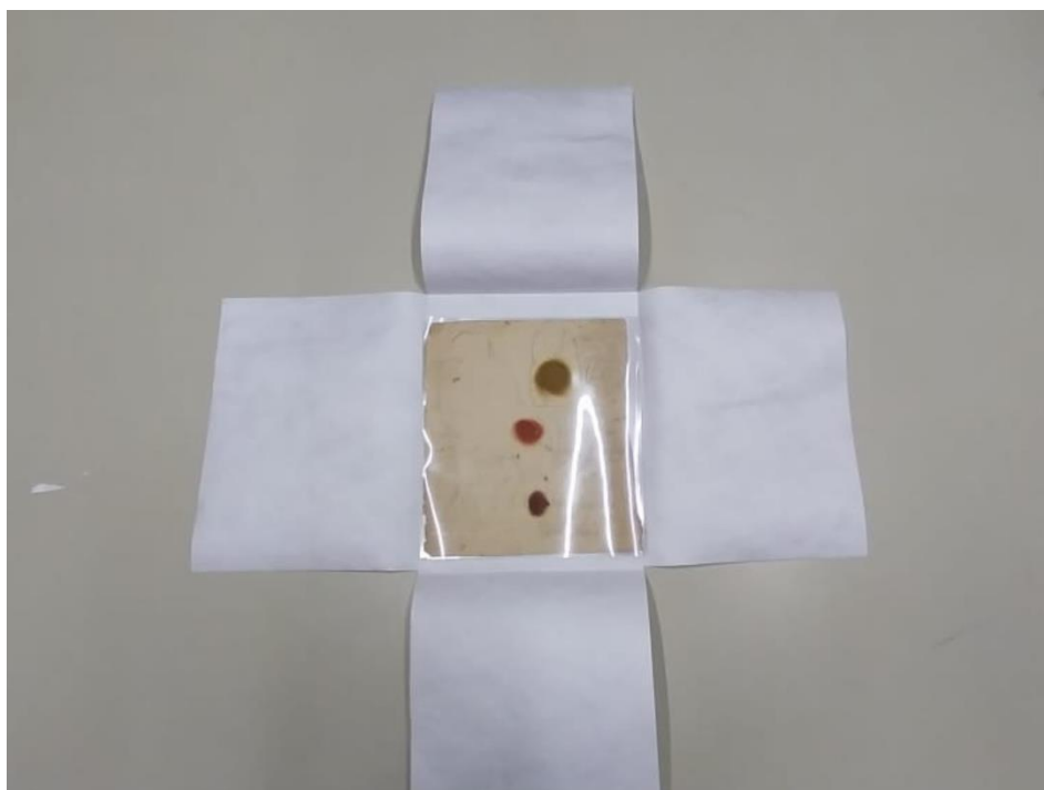
Figura 51– Acondicionamento envelope em cruz com Poliéster Mylar:
