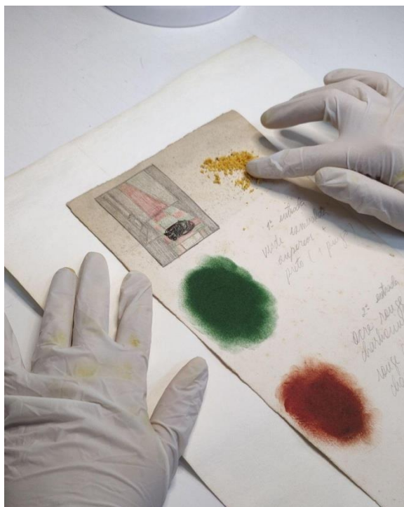
Figura 34- Utilização do pó de borracha em um material selecionado
