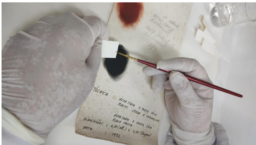
Figura 38 - Teste químico para verificar a solubilidade da tinta
