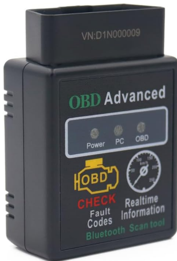
Figura 1 – ELM327 utilizado para o projeto. Fonte: Amazon, 2025
