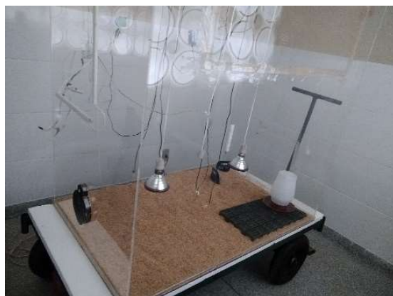
Figura 2 - Protótipo de acrílico, equipado com duas lâmpadas de infravermelho para aquecimento dos pintos e equipado internamente com sensores de monitoramento microclimático, cama de palha de arroz, comedouro e bebedouro.
