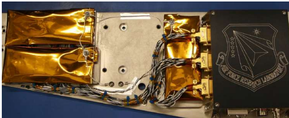
Figura 24 – Uso de isolantes térmicos em componentes eletrônicos de um cubesat ( RESEARCH LABORATORY AIRFORCE, 2021 )
