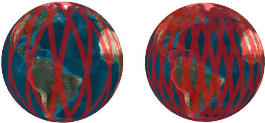
Figura 31 – Comparação da cobertura global com diferentes números de satélites simulados com o STK. Caso (a): um único satélite. Caso (b): constelação de dois satélites no mesmo plano orbital.(MOREIRA; SILVA; et al., 2024)
