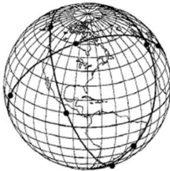
Figura 32 – Configuração orbital 65:15/3/2 do tipo Walker Delta, (WERTZ, 2007)
