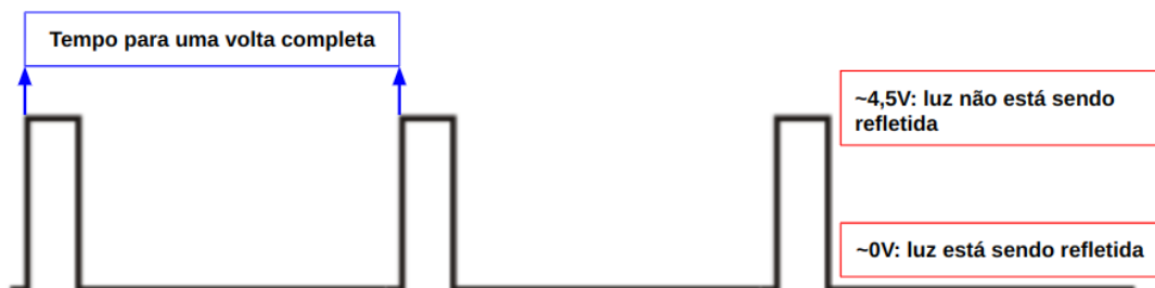
Figura 2.11 – Ilustração do sinal PWM .
