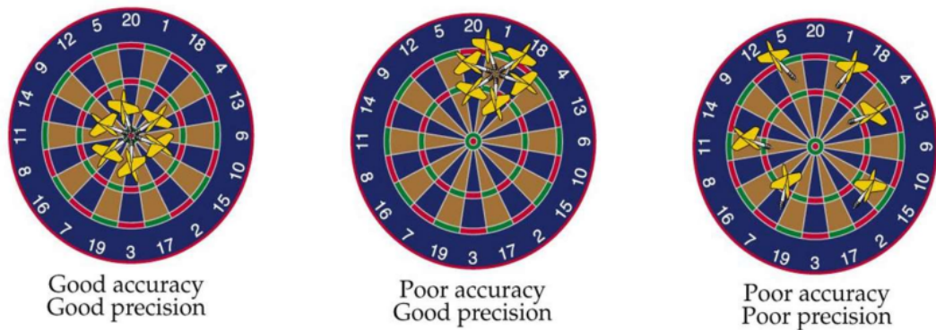
Figura 2.15 – Comparação entre exatidão e precisão de medições.
