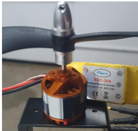
Figura 2.16 – Motor " BLDC Turnigy D2830/11 1000KV " e controlador eletrônico de velocidade " 30A BLDC ESC ".
