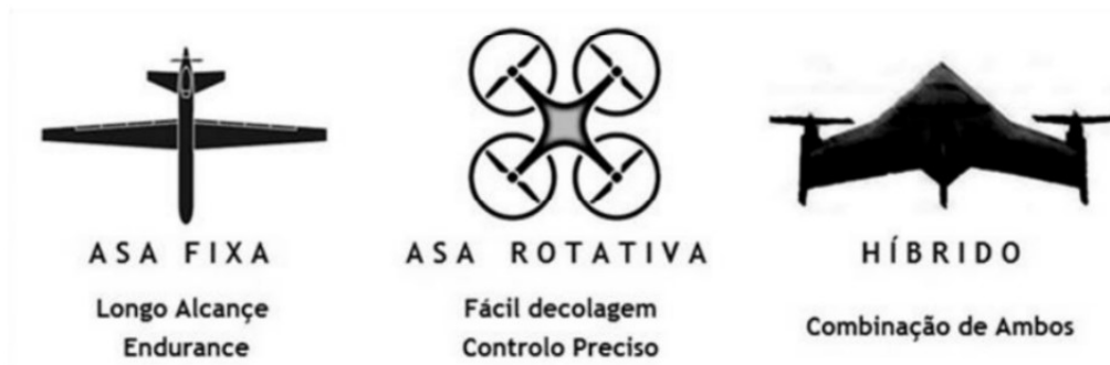
Figura 1.1 – Diferentes tipos de VANTs de acordo com as asas
