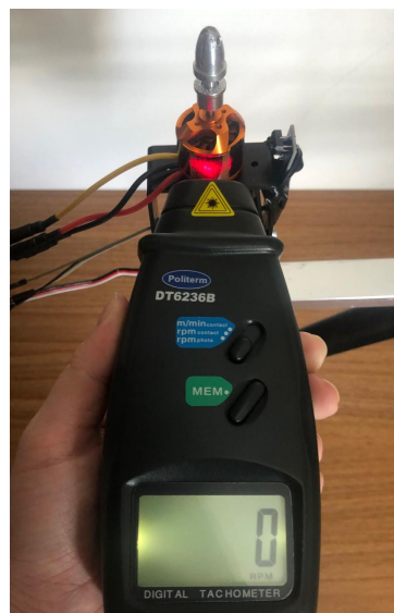
Figura 4.13 – Foto mostrando como foram feitas as medições com o tacômetro.
