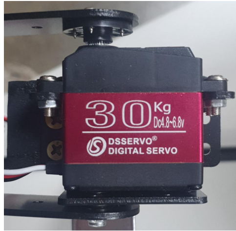
Figura 2.19 – Servo motor "DS3230".
