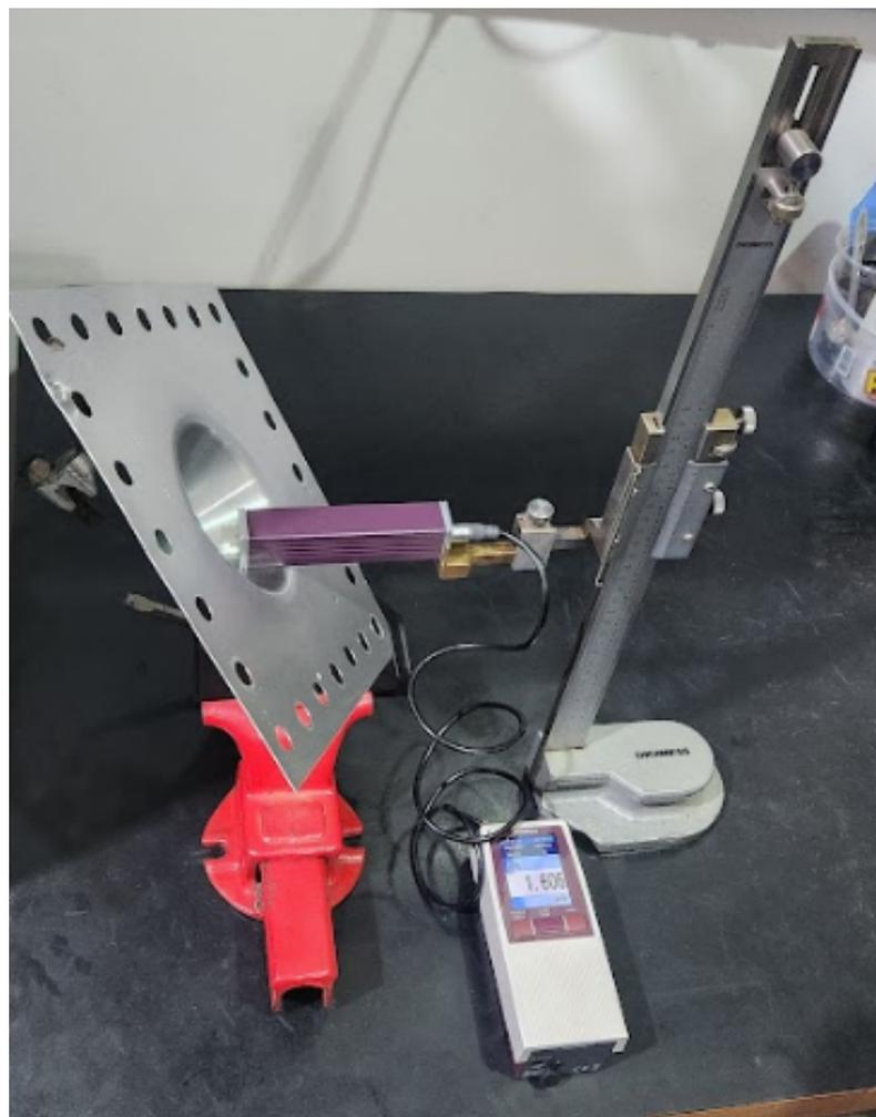
Figura 14 – Rugosímetro Mitutoyo SJ-210 posicionado na base de medição
