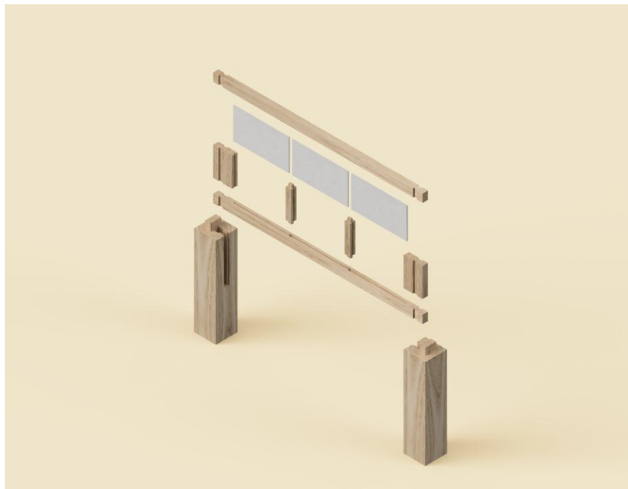
Figura 65 – Mesa MOKU-K: Vista explodida da estrutura da base.
