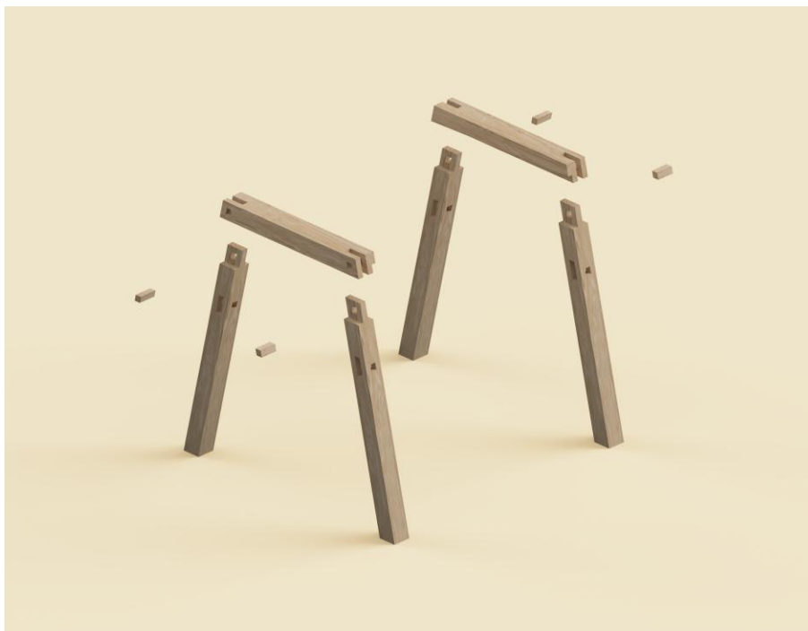
Figura 39 – Cadeira MOKU-K: Montagem da estrutura lateral.
