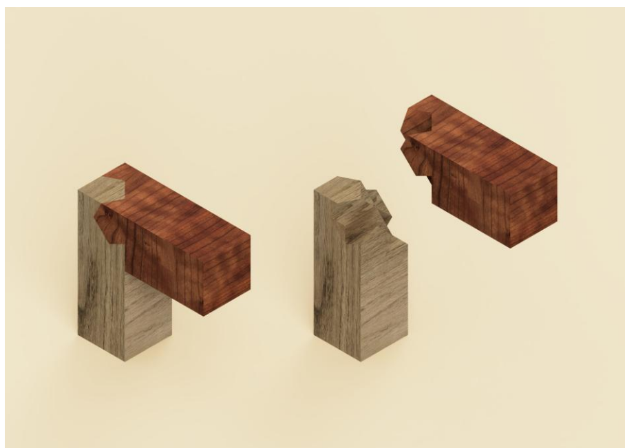
Figura 17 – Encaixe Kawai-tsugite – arranjo angulado.
