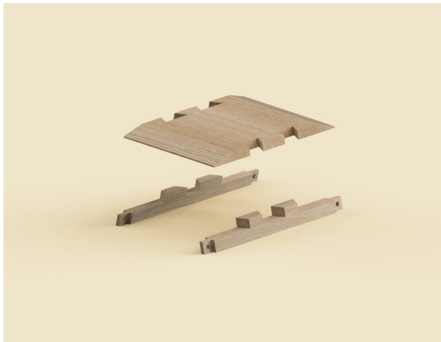
Figura 41 – Cadeira MOKU-K: Montagem do tampo do banco.
