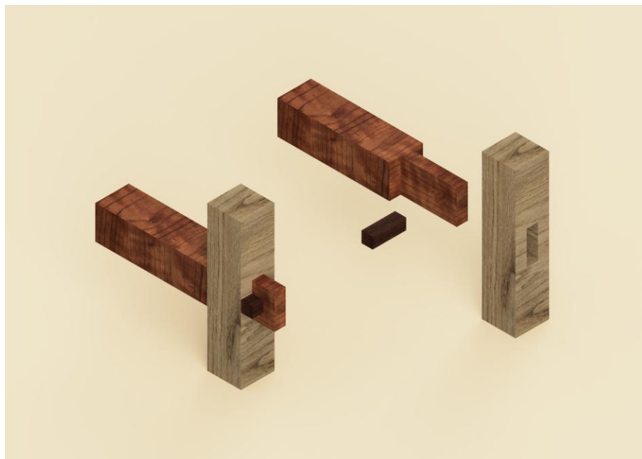
Figura 23 – Encaixe Hira-hozo-tsugi com pino de fixação Hana-sen .
