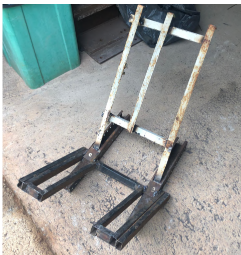
Figura 57 – Assento de mockup após corte e soldagem. fonte: autor
