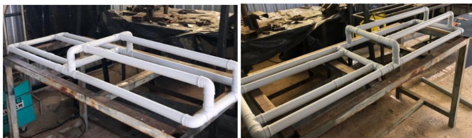
Figura 58 – Base de tubo de PVC usada no mockup (CUNHA FILHO, 2023)
