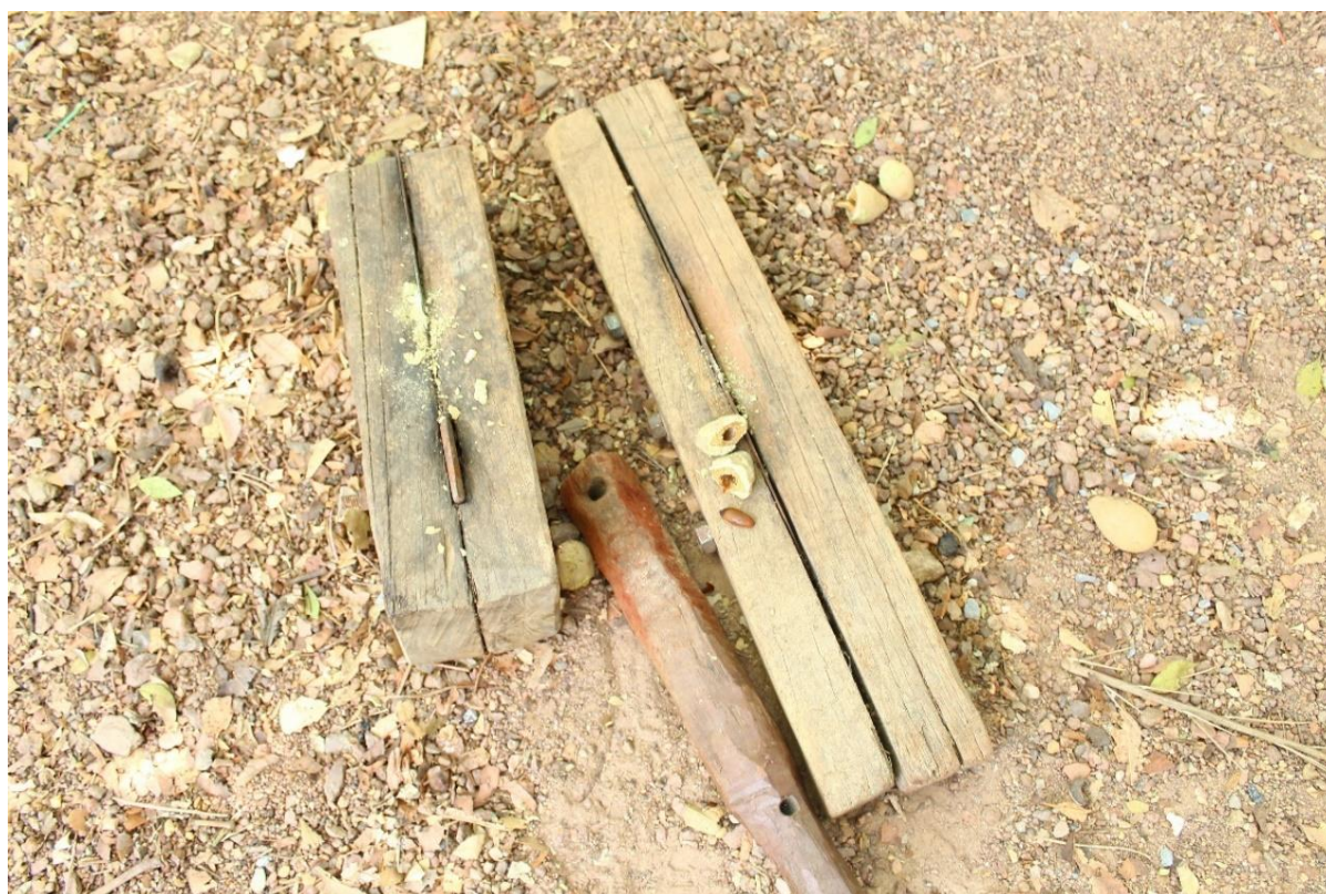
Figura 26: Máquina de quebrar baru (lâmina mais fina) e coco babaçu (lâmina mais grossa)
