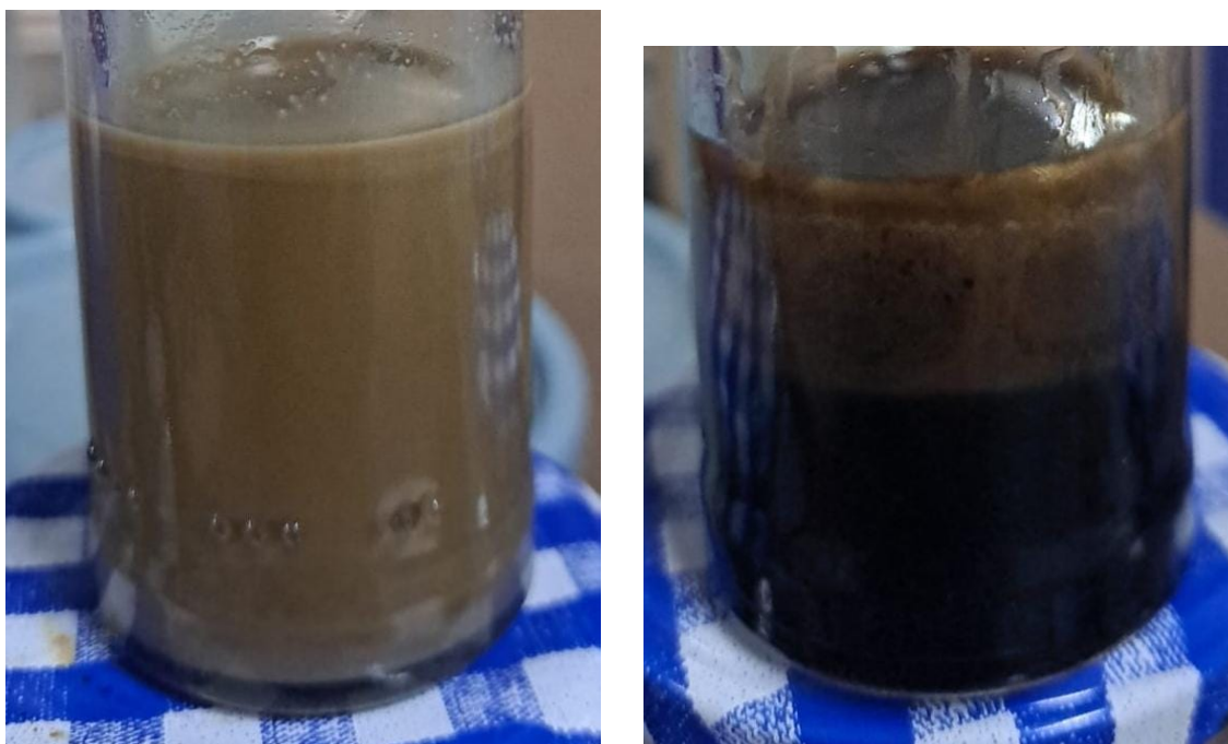
Figura 4.2: Exemplo de (esquerda) formulação estável, sem separação de fases visível, e (direita) formulação instável, onde se observa segregação da fase oleosa.
