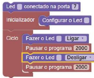
Figura 4.4: Exemplo ilustrativo de programação em blocos para iniciantes, demonstrando o controle de um LED (pisca-pisca) e os conceitos de inicialização e ciclo de execução.
