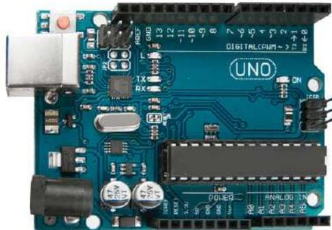
Figura 3.3: Arduino Uno com ATmega328
