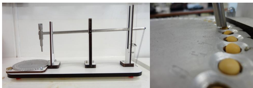
Figura 4. Pêndulo para teste de resistência de sementes de soja à danificação mecânica.
