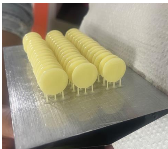
Figura 1: Espécimes após impressão 3D em angulação de 90°.
