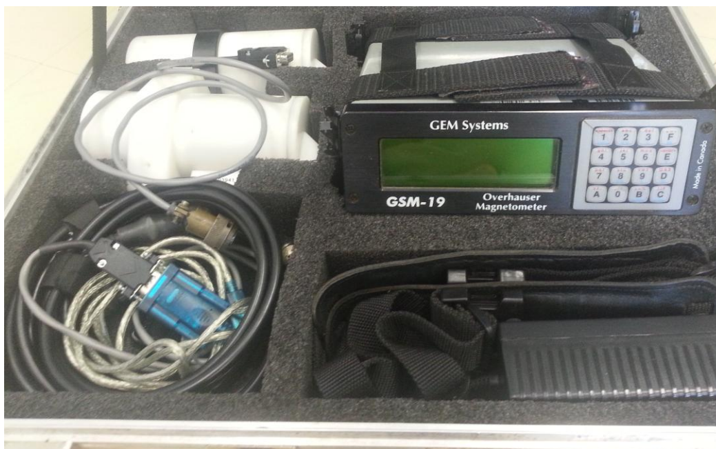
Figura 2.6 – Foto do magnetômetro GSM-19 Overhauser: unidade de controle, bobina e cabos.
