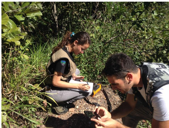
Figura 2.2 – Fotografia evidencia a aquisição de dados radiométricos com o equipamento Super Spec RS230 em um afloramento rochoso.
