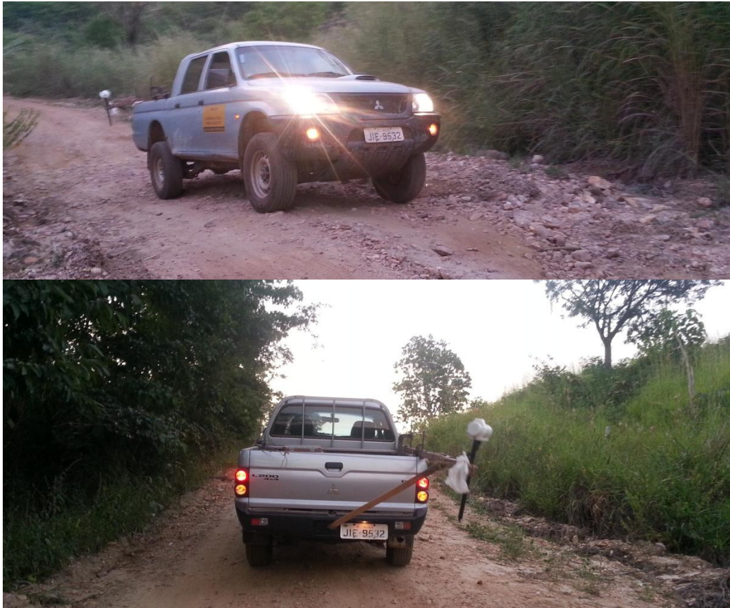
Figura 6.23 – Magnetômetro rover acoplado ao carro
