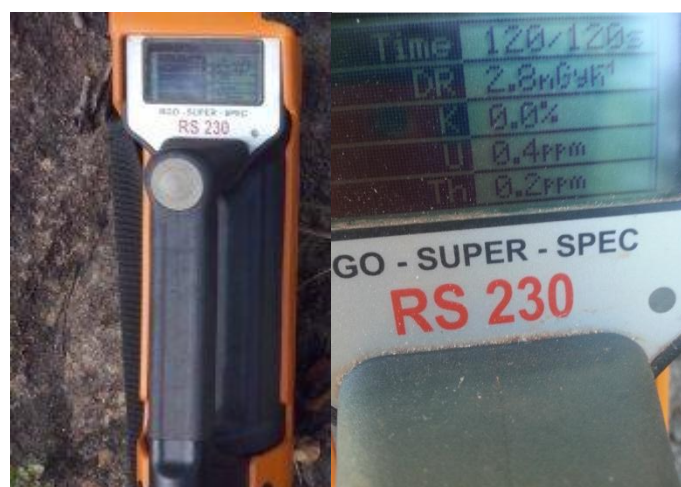
Figura 6.2 – Gamaespectrômetro portátil Super Spec RS-230 BGO.
