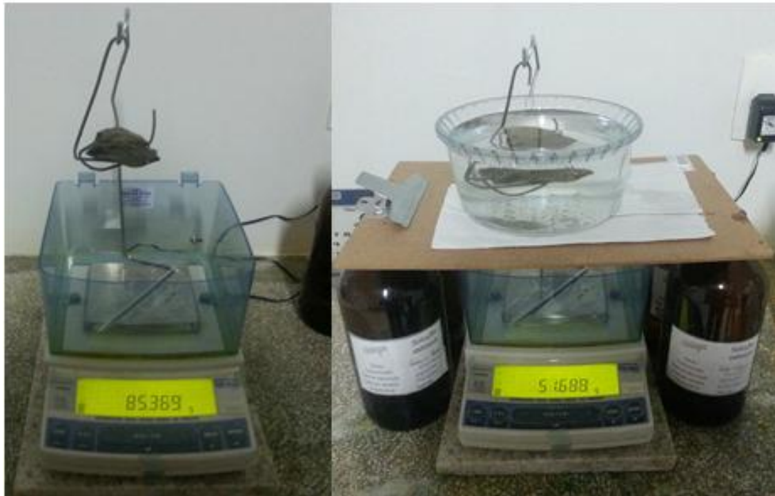
Figura 6.16 – Esquema da balança usada para medir o peso das amostras. À esquerda leitura do peso seco e à direita a mesma amostra com leitura do peso aparente (com os poros preenchidos) imersa em água destilada.
