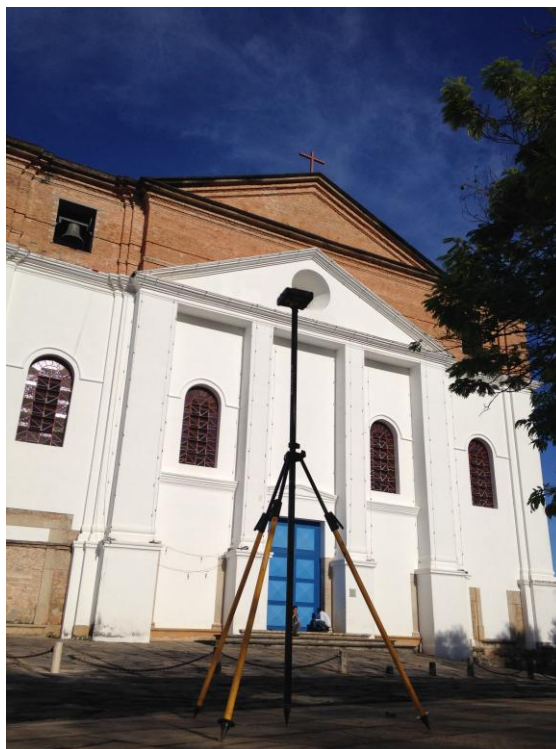
Figura 2.3 – Fotografia evidencia a posi  o do GPS geod sico Topcon Hiper Lite+ e grav metro. Base gravim trica na soleira   direita na porta de entrada da Igreja Matriz de Santana na Pra a Castelo Branco em Goi s/GO.
