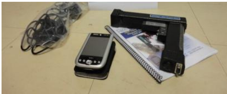
Figura 2.7 – Foto do medidor portátil de susceptibilidade magnética e cabos. Hand-Held Conductivity & Magnetic Susceptibility Meter no centro e o Multiparameter Probe à direita.
