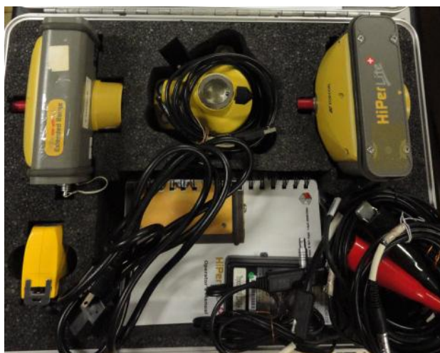
Figura 2.4 – Foto evidencia os receptores GNSS, base nivelante, cabos de alimenta  o e transfer ncia de dados, usados no desenvolvimento do projeto.
