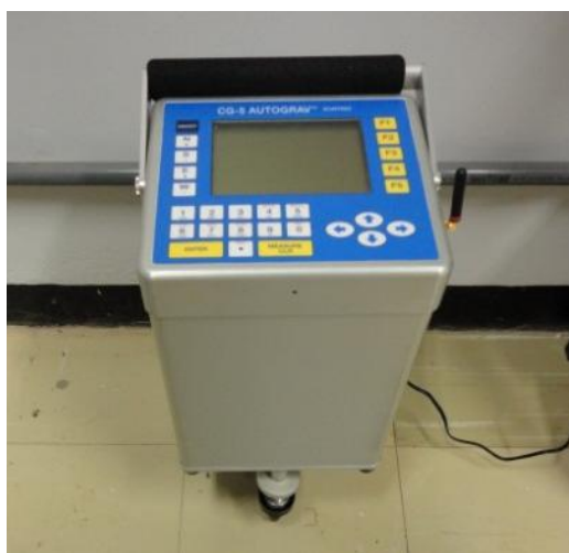
Figura 2.5 – Foto evidencia o gravímetro modelo CG5 da Scintrex.
