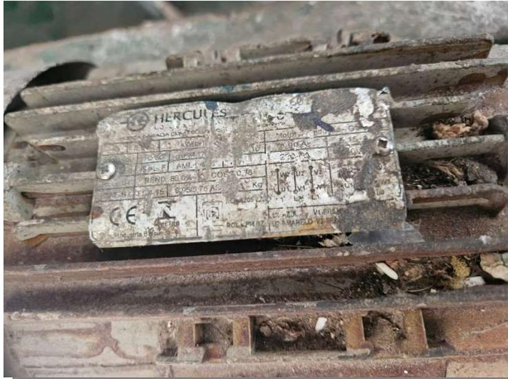
**Figura 7 - Placa identificação danificada.**
