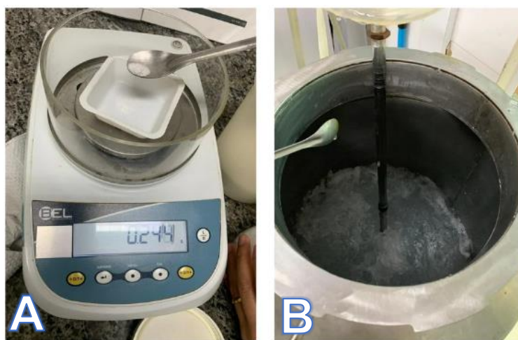
Figura 5. A) Pesagem dos reagentes do meio de cultura. B) Reagentes sendo misturados no misturador de 48 litros. (Autoria própria).
