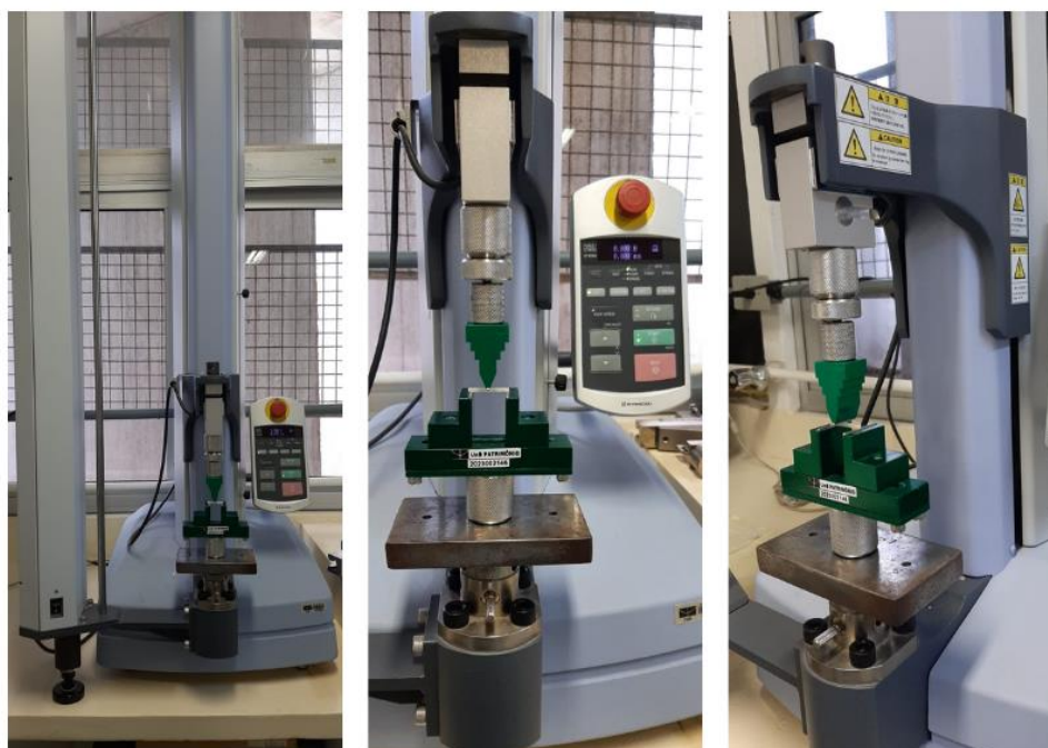
Figura 2: Dispositivo e posicionamento da barra para avaliação da resistência flexural
