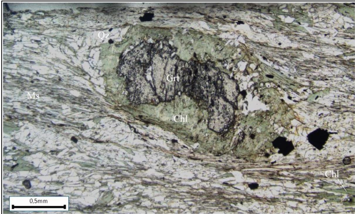
**Figura 5. 27:** Fotomicrografia com polarizador paralelo de porfiroblasto de granada com cristais de quartzo inclusos. As lamelas de clorita e muscovita, que definem a foliação Sn, encontram-se arqueadas no contato com a granada. Lâmina de Granada Muscovita Clorita Xisto com Magnetita (ponto TF22-VII-31).
