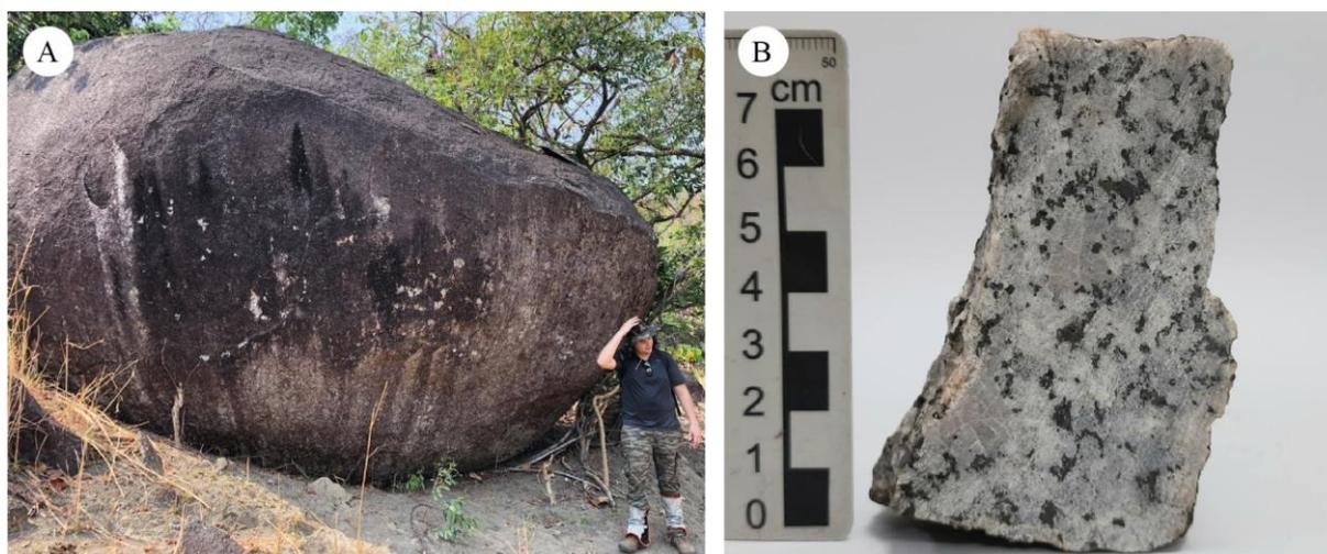
**Figura 6. 2:** Em A matacão pertencente à fácies granítica do Plúton Faina com potencial para exploração da indústria de revestimentos. Em B amostra de mão destacando-se a coloração clara da rocha e os cristais centimétricos de plagioclásio.
