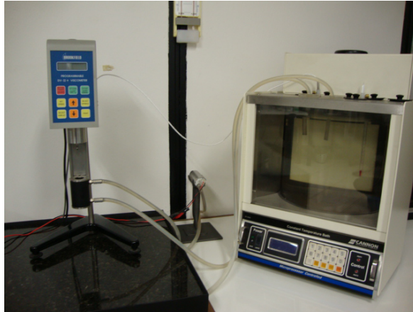
Figura 3.9: A bancada com o viscosímetro, o banho térmico e o sistema de bombeamento de água do banho para a cavidade do viscosímetro, permitindo assim um controle rígido da temperatura do fluido ensaiado. (Laboratório do Vortex - ENM - UnB)
