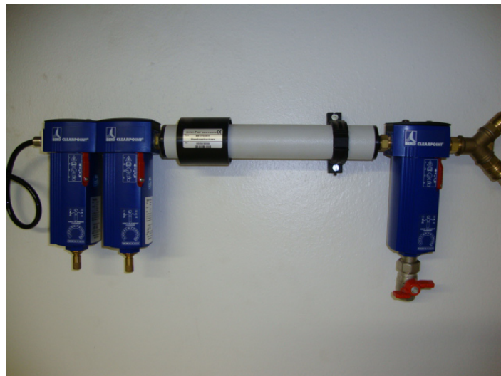
Figura 3.13: Filtro da marca Beko Clearpoint responsável pelo tratamento do ar que sai do compressor e vai até o reômetro. (Laboratório do Vortex - ENM - UnB)
