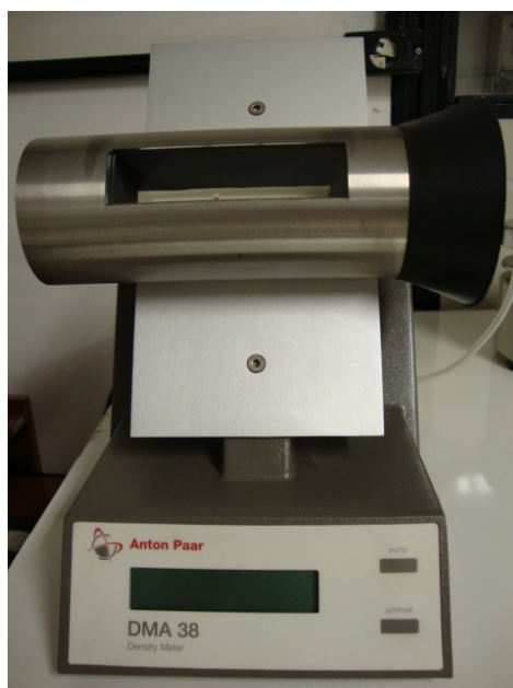
Figura 3.7: Densímetro DM38 da marca Anton Paar que funciona baseado no princípio de tubo em U. É necessária uma amostra de 2\text{ ml} do fluido. (Laboratório do Vortex - ENM - UnB)
