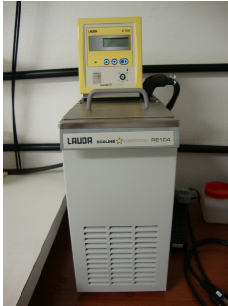
Figura 3.12: Equipamento da marca Lauda responsável pelo controle da temperatura do fluido em estudo. O funcionamento é baseado no efeito Peltier. (Laboratório do Vortex - ENM - UnB)
