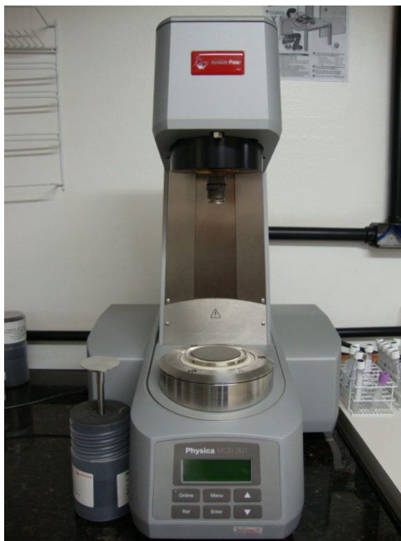
Figura 3.11: Reômetro MCR 301 da marca Anton Paar, que funciona baseado no princípio de escoamento entre disco rotativo e placa plana. (Laboratório do Vortex - ENM - UnB)
