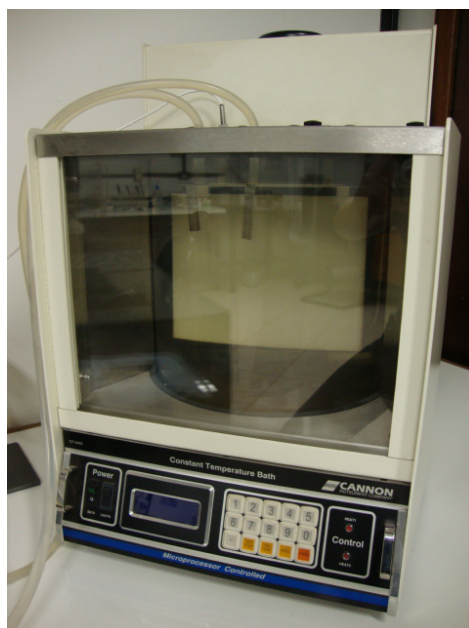
Figura 3.6: Banho térmico CT-200 Cannon, que funciona com uma resistência elétrica. Possui resolução de 0,001^{\circ}\text{C} (Laboratório do Vortex - ENM - UnB)
