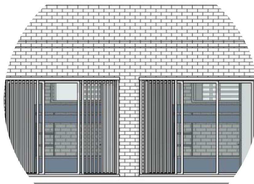
Porta com elementos verticais para barrar a incidência solar
