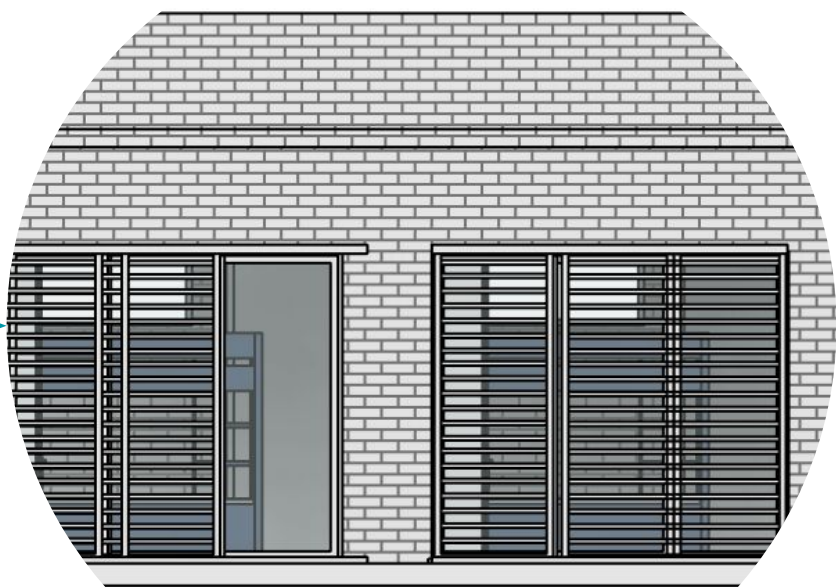
Porta com elementos horizontais para barrar a incidência solar
