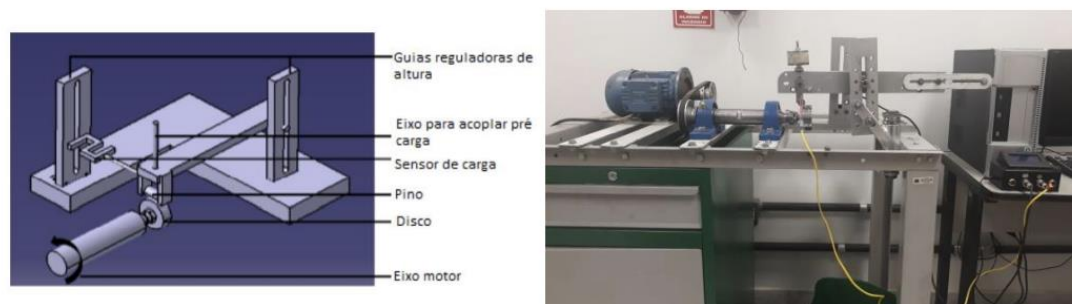
Figura 11 - Tribômetro Laboratório de Tribologia UnB Gama. Fonte: (MARINHO; GUSTAVO; GALÁRRAGA, [s.d.])
