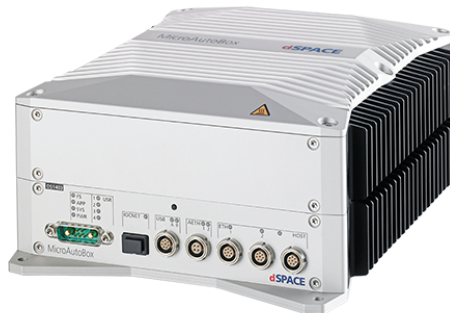
Figura 32 – ECU genérica da Dspace MicroAutoBox III
