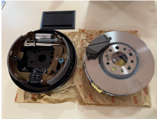
Figura 39 – Sistema de freio utilizado no veículo em questão
