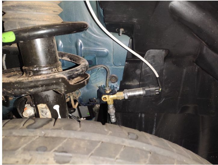
Figura 58 – Transdutor de pressão montado na linha de freio à 90° de inclinação
