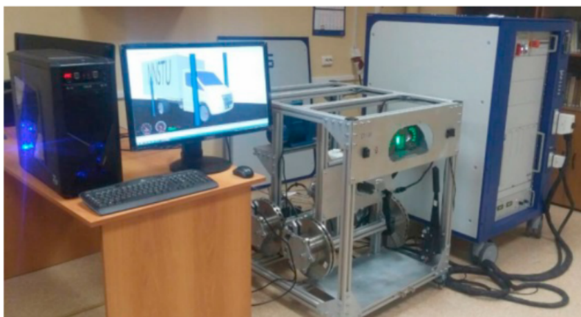
Figura 2 – Simulação da bancada de freios em Hardware-in-the-loop . Tumasov u. a. (2019).
