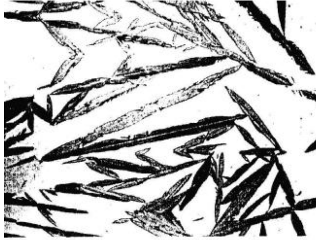
Figura 17-Placas de Martensita em “zig-zag”
